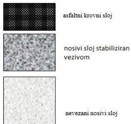
Slika 4.20: Asfaltna kolnička konstrukcija sa dva nosiva sloja: kameni agregat stabiliziran bitumenom ili cementom i nevezani kameni agregat (Žmavc, 2005)
