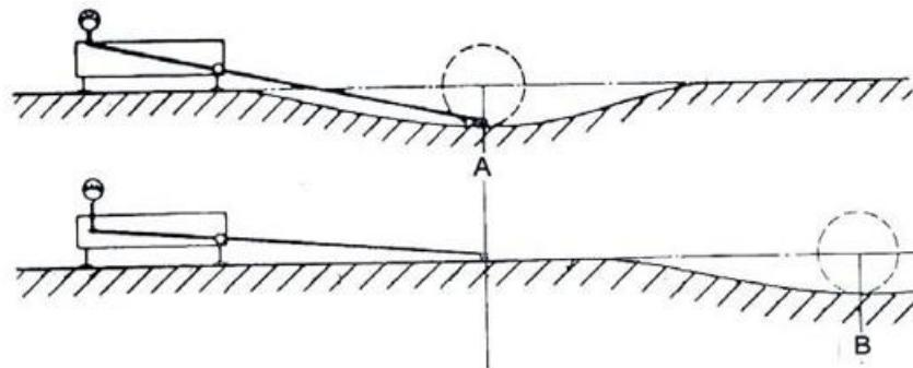
Slika 4.13: Shematski prikaz mjerjenja elastičnog ugiba površine kolničke konstrukcije Benkelmanovom gredom [FGSV, 1991]
