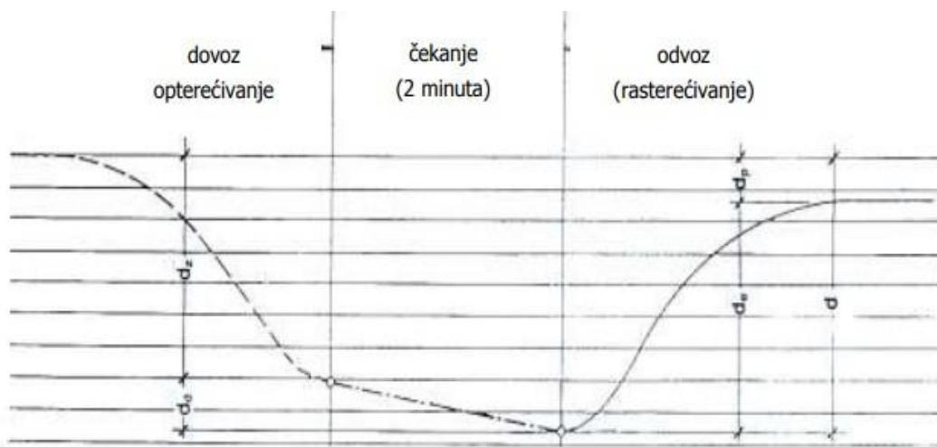
Slika 4.12: Shematski prikaz mjerjenja ukupnog pomaka površine kolničke konstrukcije [FGSV, 1991]
