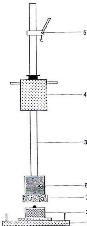
Slika 4.7: Shema kružne ploče sa opremom za dinamičko opterećenje kao i za mjerjenje slijeganja (Žmavc, 2005)
