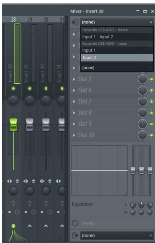
Slika 10. Povezivanje ulaza audio sučelja sa mikser kanalom
