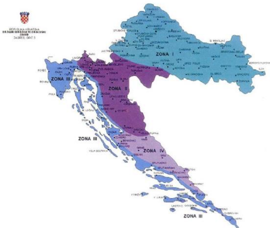
Slika 2.3.1 Klimatske zone karakterističnog opterećenja snijegom[3]
