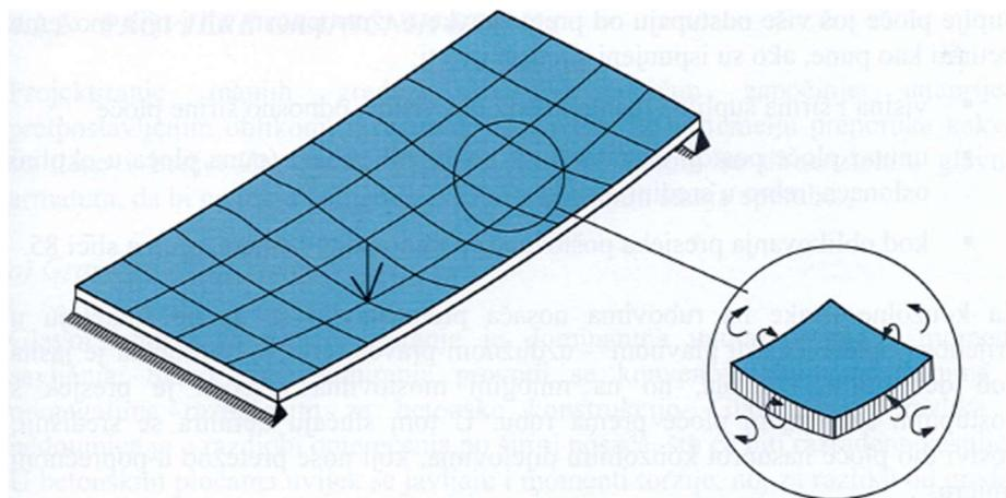
Slika 29: Progib ploče pod koncentriranim opterećenjem
