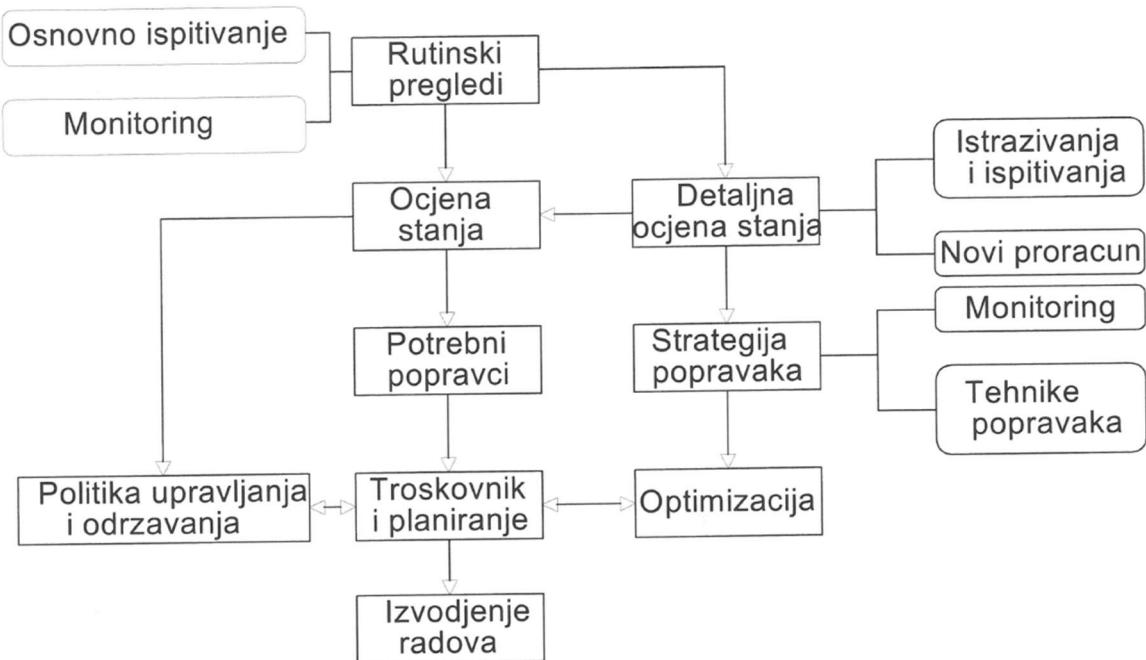
Slika 12: Glavne aktivnosti u procesu ocjene stanja betonskog mosta
