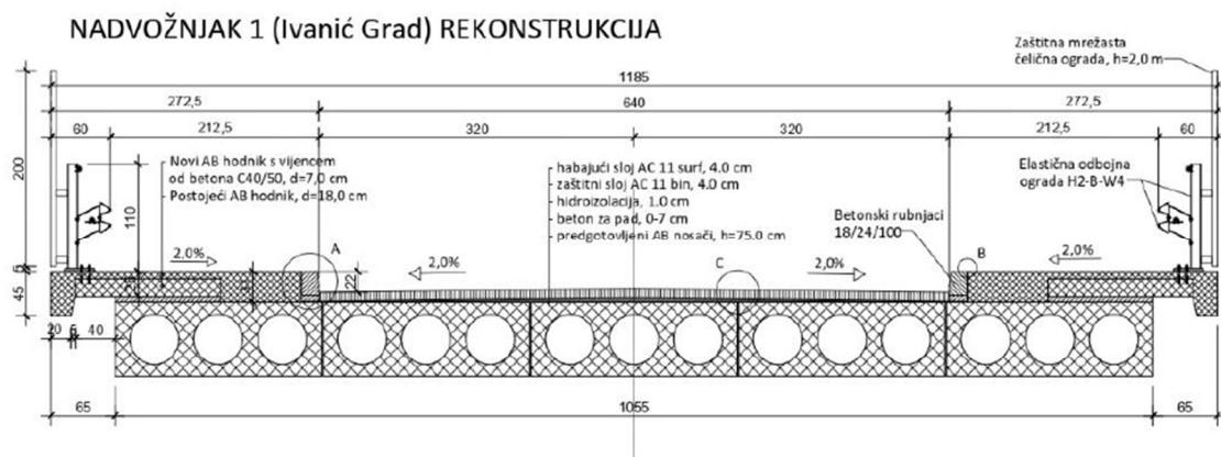
*Slika 10: Poprečni presjek nadvožnjaka 1 (Ivanić Grad) nakon obavljenе rekonstrukcije
