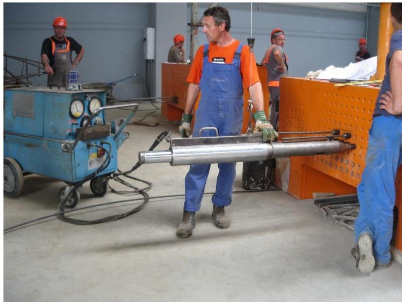
Slika 2.6 Hidraulička preša za zatezanje
