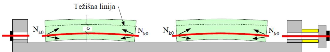
Slika 2.3. Presjecanje užadi nakon što beton dovoljno očvrsne
