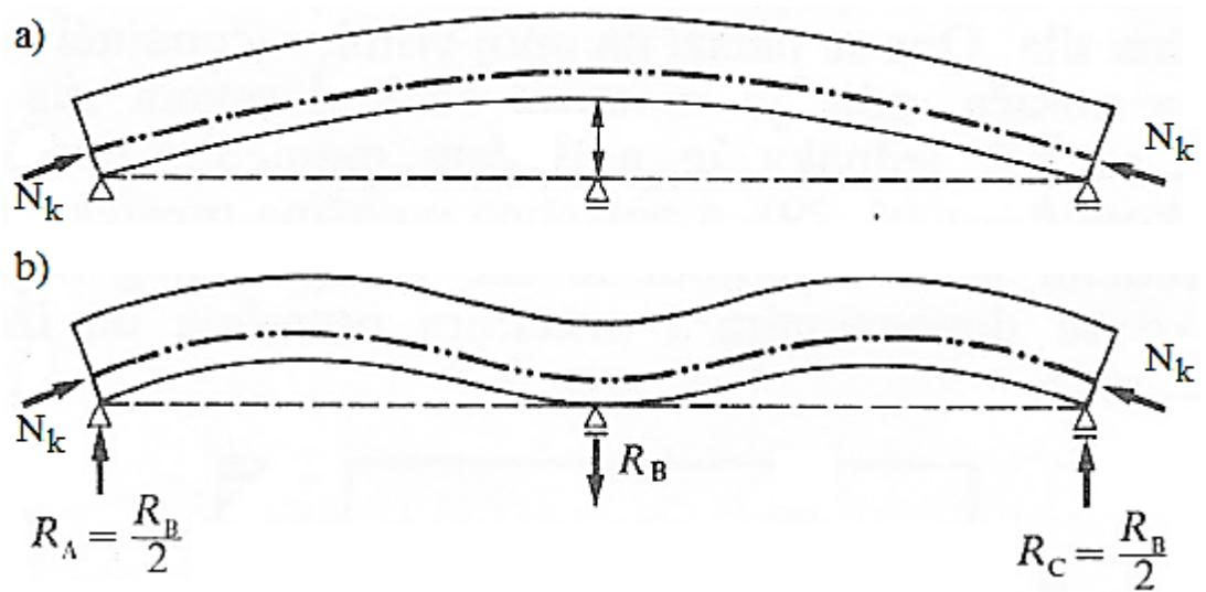
Slika 3.6 Nosač nakon djelovanja sile prednaprezanja; a) bez medupotpore, b) sa medupotpored
