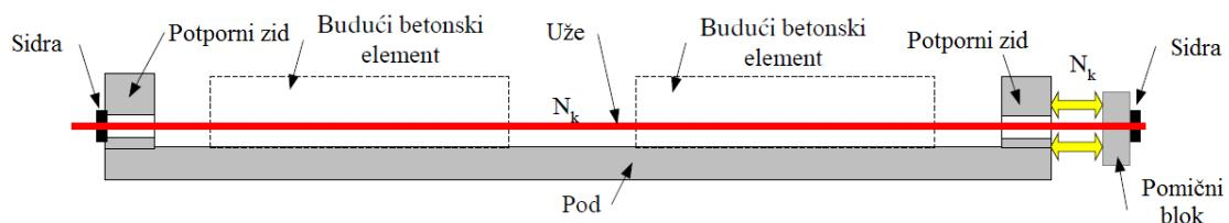
Slika 2.2 Zatezanje i usidravanje užadi između dva potorna zida na krajevima staze
