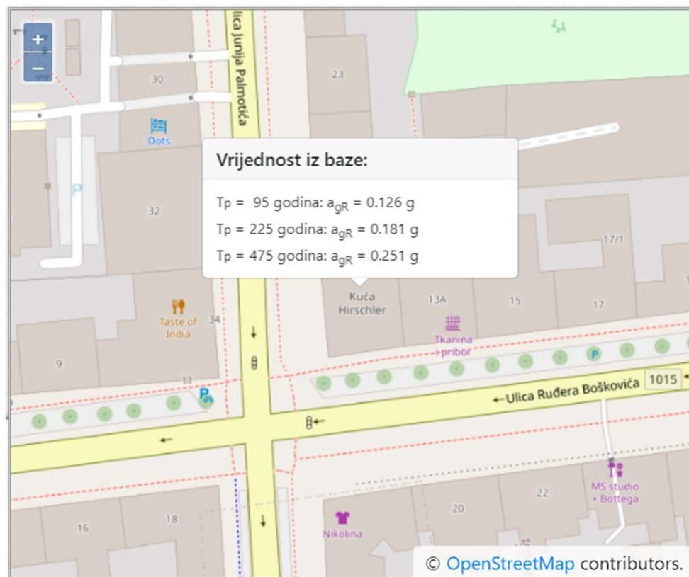
Slika 2.21 Lokacija predmetne zgrade sa horizontalnim vršnim ubrzanjima tla tipa A ( $a_{gR}$ ) za povratna razdoblja od  $T_p = 95, 225$  i  $475$  godina [9]
