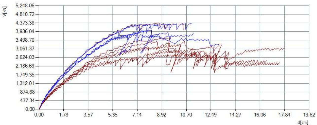
Slika 3.15 Pushover krivulja s analiziranim bočnim opterećenjem u linearном trokutastom obliku (plava boja označava X smjer, a crvena Y smjer)
