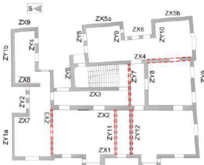
Slika 2.15 Prikaz nosivih zidova zgrade s pripadajućim oznakama
