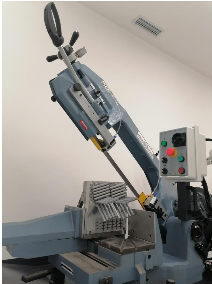
Slika 29 - Tračna pila za metal CY210A, Farrox
