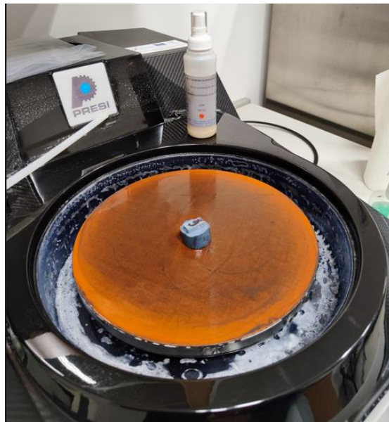
Slika 41 - Poliranje s 9 \mu\text{m}
