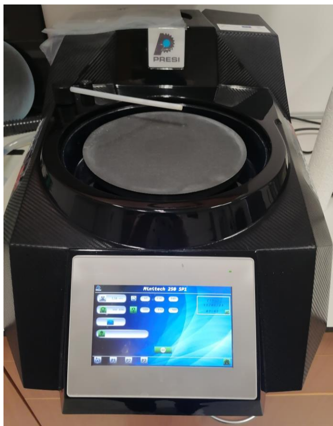
Slika 36 - 'Presi' uređaj z a poliranje i brušenje
