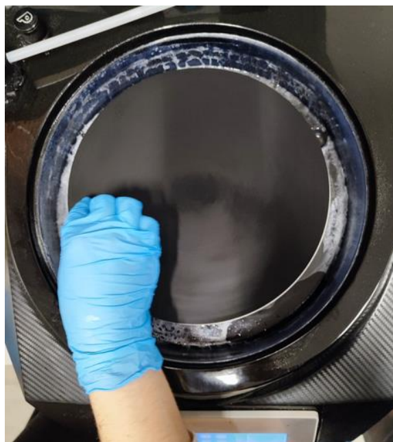
Slika 44 - Poliranje s 0,3 \mu m
