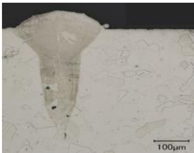
Slika 11 – Greške u mikrostrukтури tipa „Keyhole“ [7]
