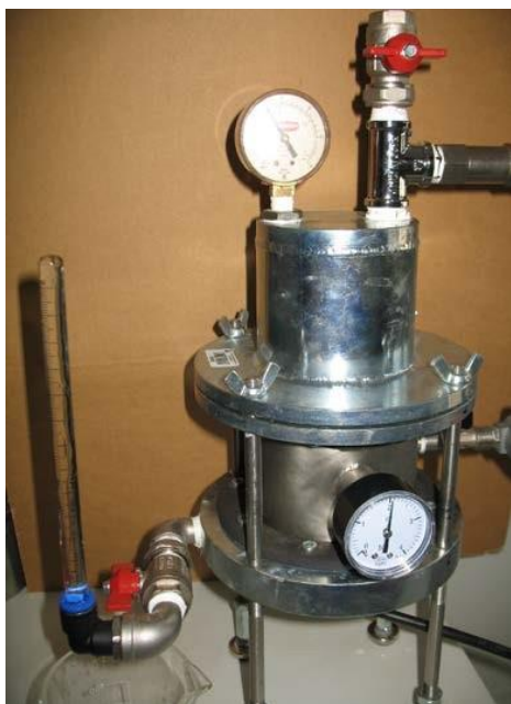
Slika 90. Uređaj za određivanje vodopropusnosti
