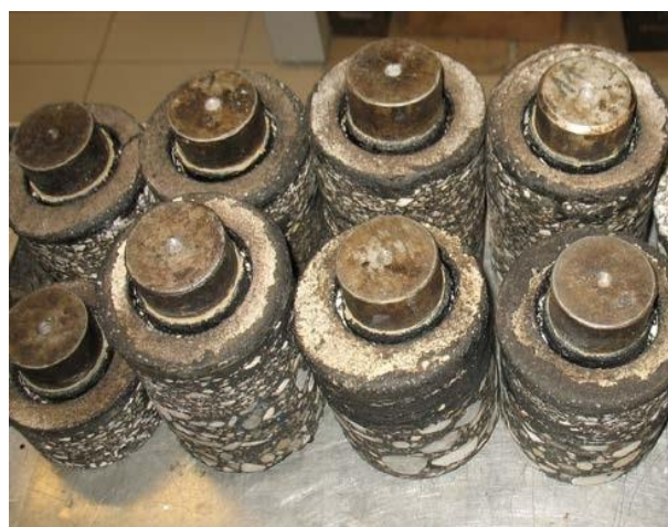
Slika 87. Uzorci za ispitivanje povezanosti
