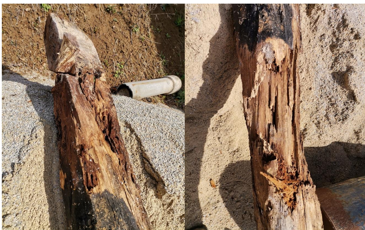
Slika 3.27: Prikaz istrunule građe nastale uslijed prokišnjanja
