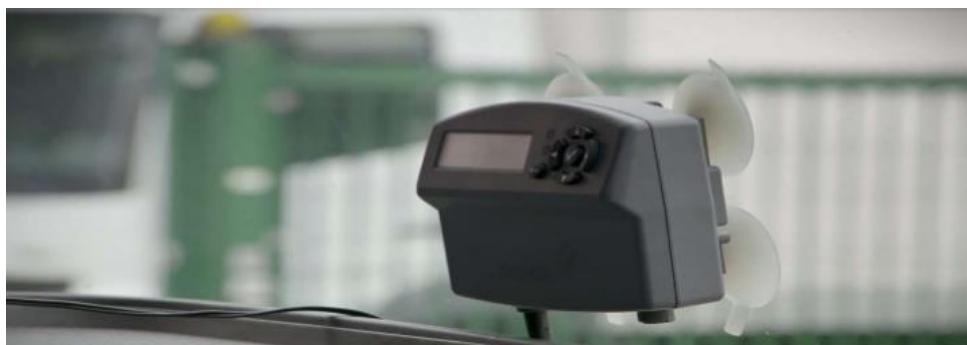
**Slika 7. Prikaz OBU elektronske jedinice u vozilima**
