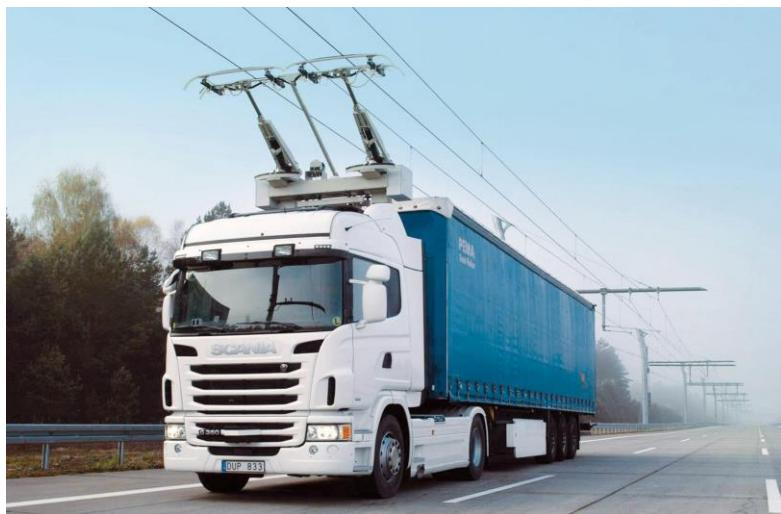
**Slika 1.** Hibridni kamion s pantografom tvrtke Scania
