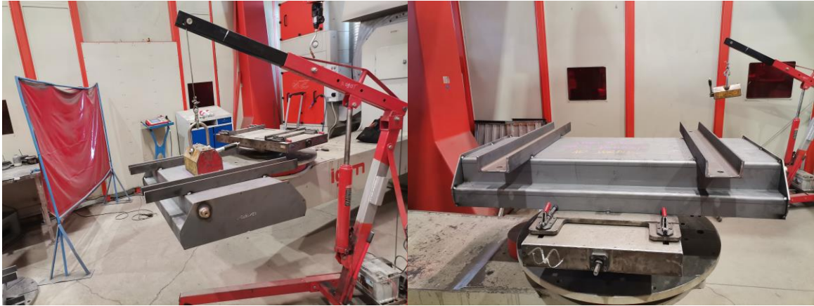
Slika 5.17. Stavljanje dna na pozicioner [osobne slike]
