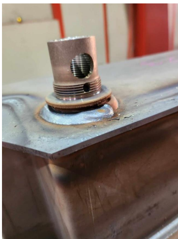
Slika 5.31. Dobiveni zavareni spoj na ispustu [osobne slike]
