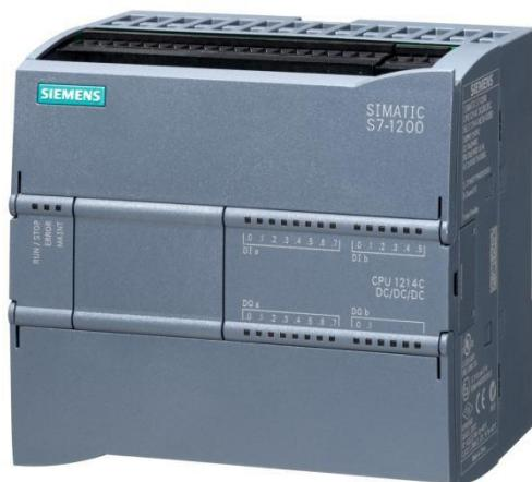
Slika 20. Siemens S7-1214C DC/DC/DC [9]
