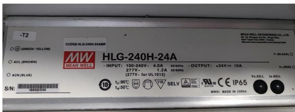
Slika 27. Fotografija korištenog transformatora
