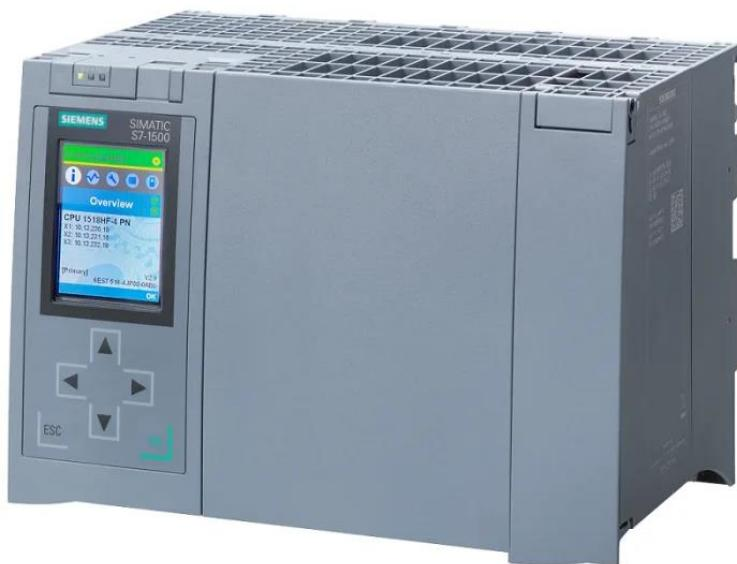
Slika 3. Primjer PLC-a: Siemens S7-1500 [5]
