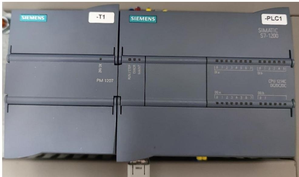
Slika 28. Fotografija korištenog PLC-a i napajanja
