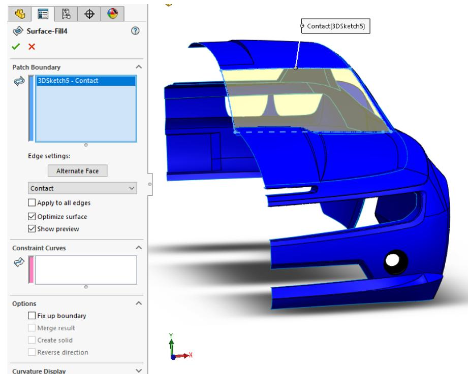
Slika 3.9. Prikaz alata „Surface fill“
