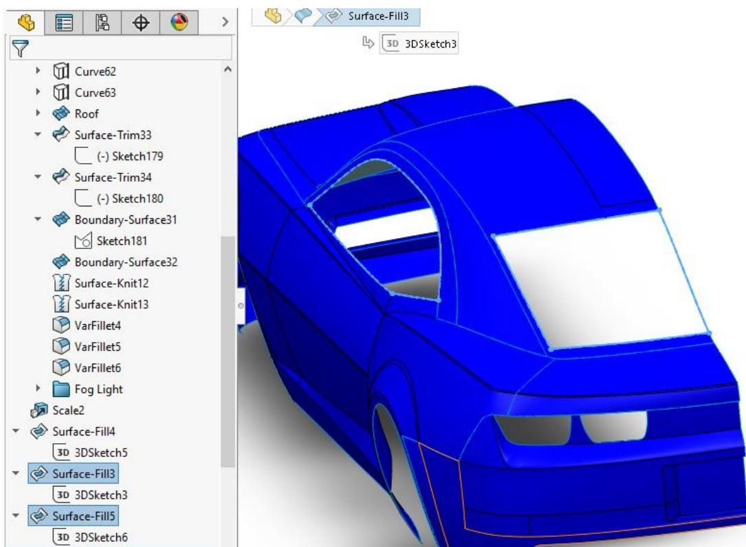
Slika 3.10. Korištenje alata „Surface Fill“ za ostala stakla
