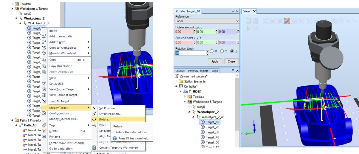
Slika 4.16. Rotiranje alata u prvoj točki (*engl. Target\_10*)
