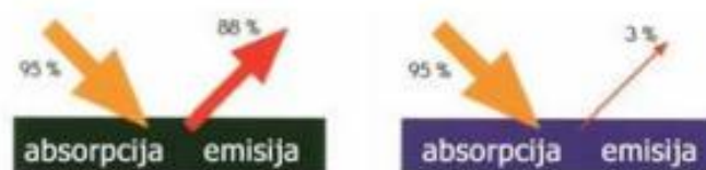
Slika 4.1. Klasična i selektivna površina (preuzeto s interneta)
