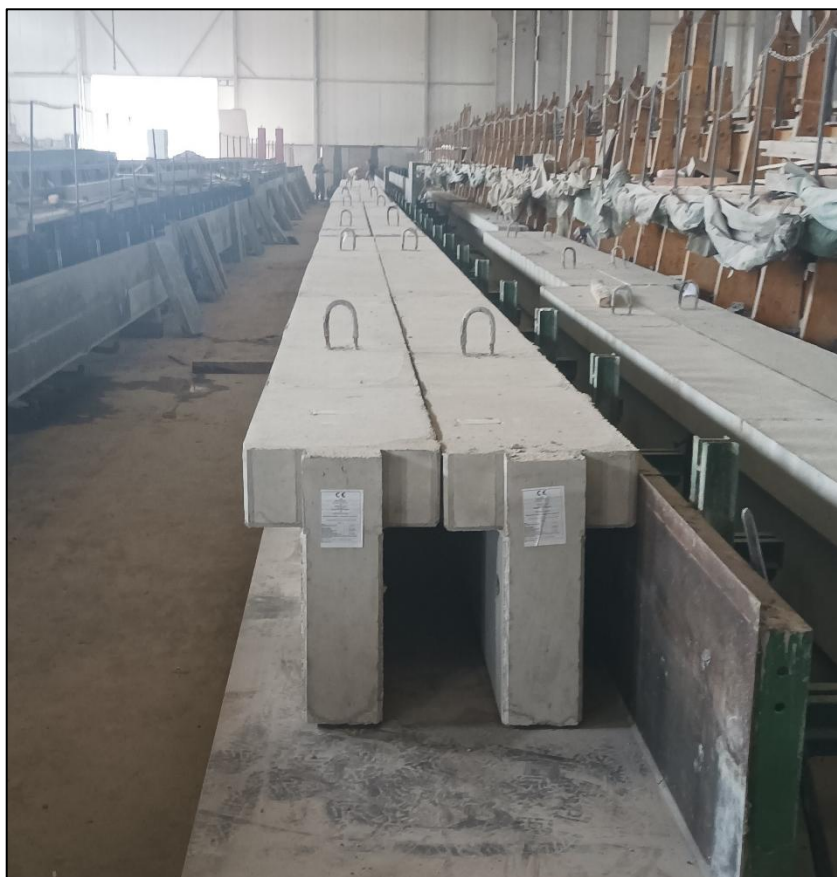
Slika 7: Montažna Ab grede T poprečnog presjeka (izvor: osobna arhiva)
