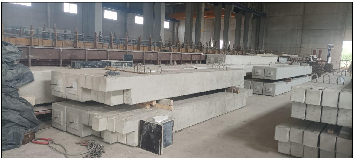
Slika 32: Odlaganje gotovih grednih elemenata u pogonu Beton Lučko d.o.o. (izvor: osobna arhiva)
