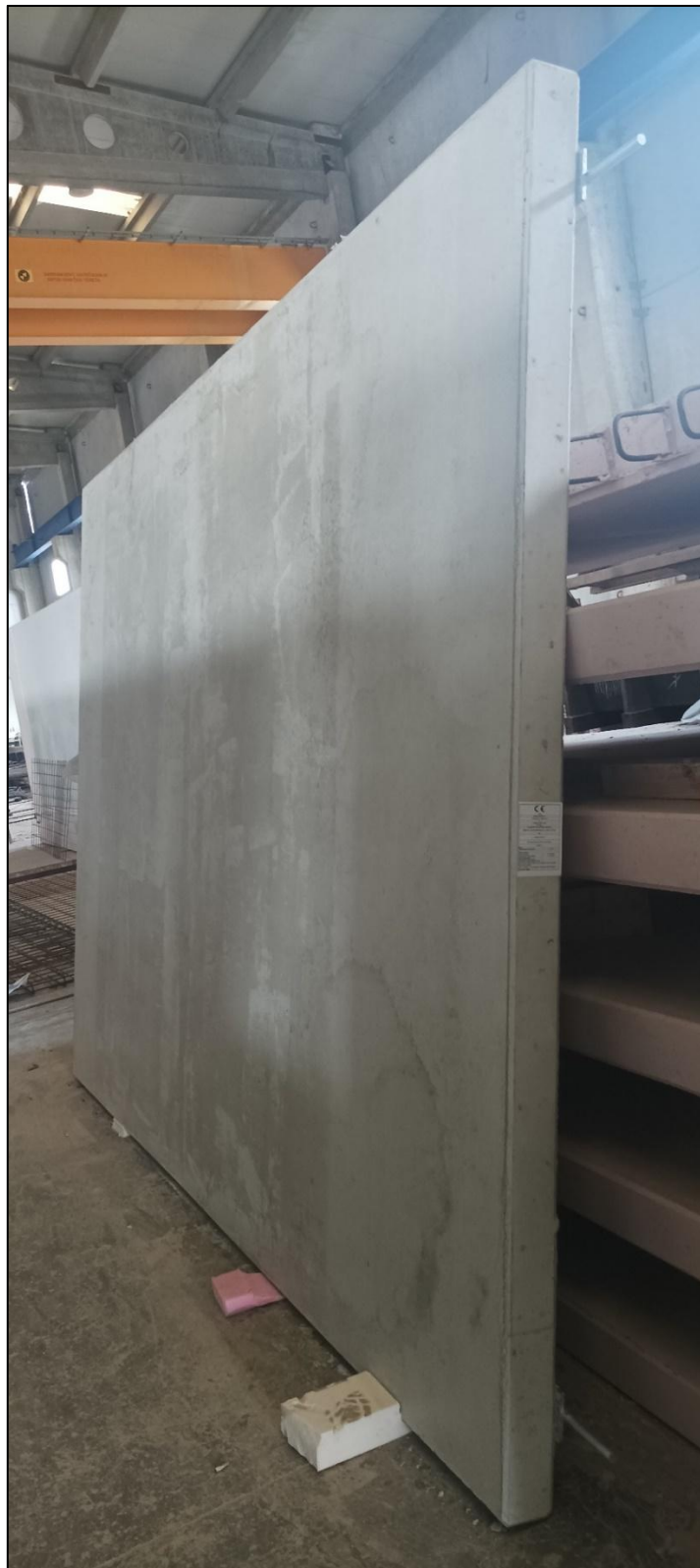
Slika 8: Montažne armirano betonske ploče punog poprečnog presjeka (izvor: osobna arhiva)
