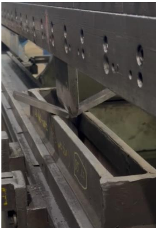
Slika 5.12.: Savijanje uzorka na stroju za savijanje [34]
