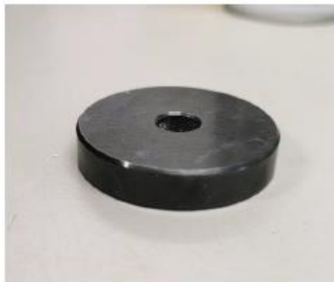
Slika 3.13.: Etalon za magnetsko ispitivanje [18]
