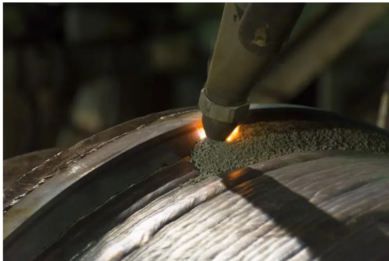
Slika 2.3.: Elektrolučno zavarivanje pod zaštitom praška [6]
