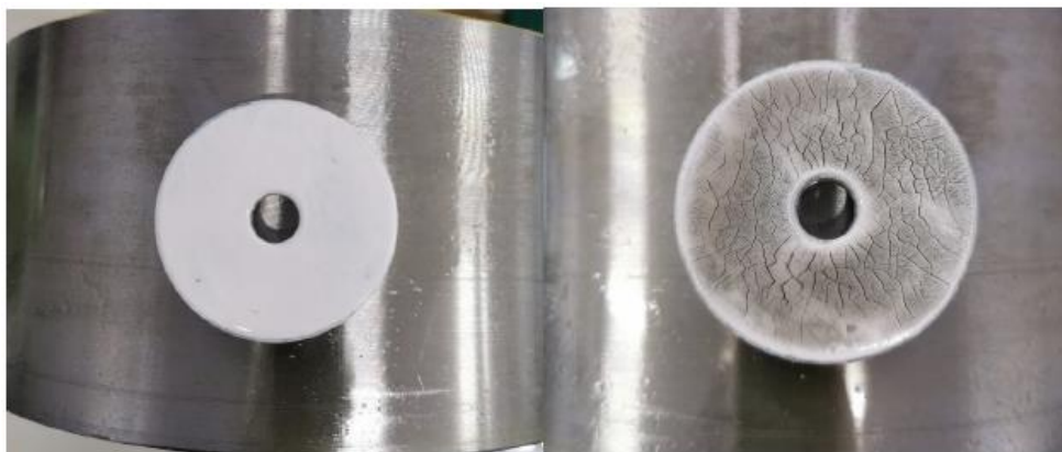
Slika 3.14.: Magnetsko ispitivanje na etalonu korištenjem nefluorescentnih čestica [18]
