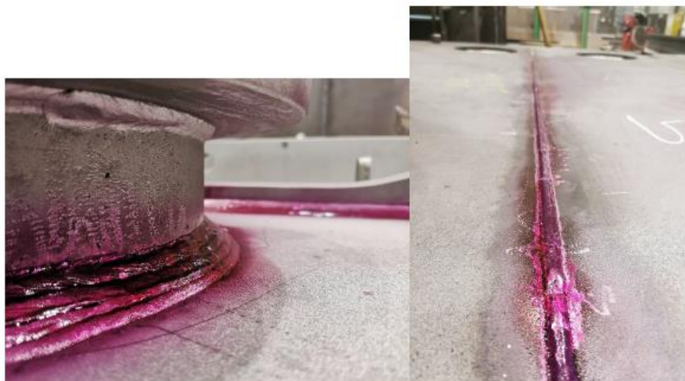
Slika 3.7.: Naneseni crveni penetrant [18]
