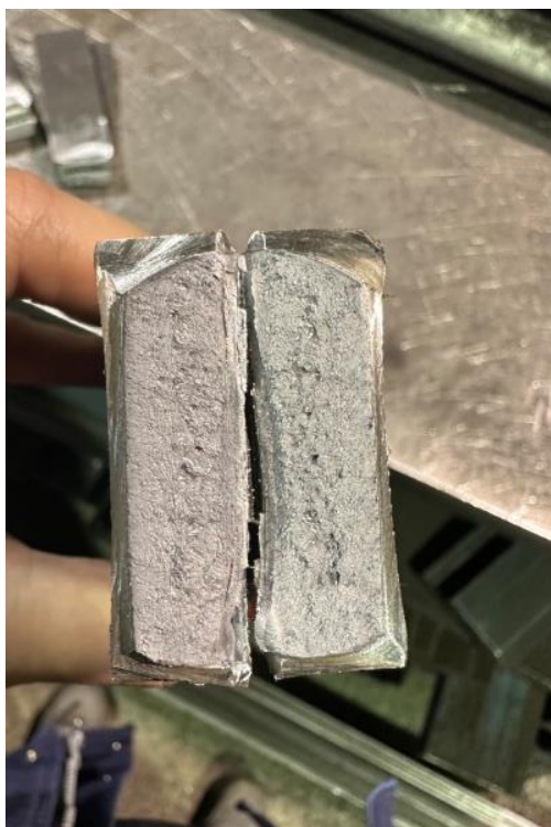
Slika 5.13.: Presjek zavarenog uzorka nakon prijeloma [34]
