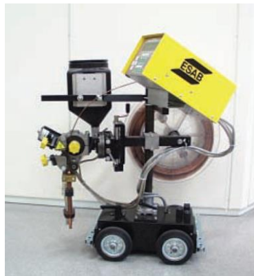
Slika 5.2.: Automat za EPP zavarivanje [33]
