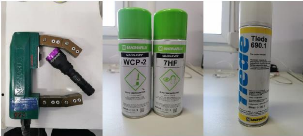
Slika 3.12.: Oprema za magnetsko ispitivanje [18]
