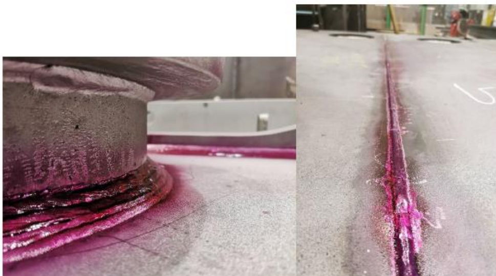
Slika 3.7.: Naneseni crveni penetrant [18]
