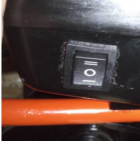
Slika 3.14. Sklopka za biranje smjera kretanja prema naprijed ili natrag
