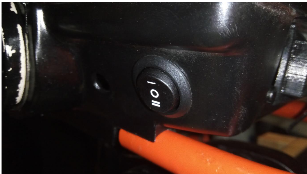
Slika 4.17. Prekidač za biranje akumulatora
