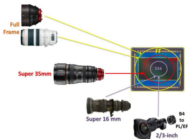
Slika 5.16 - EOS C500 Mark II može se koristiti s kinematografskim i televizijskim objektivima [8]
