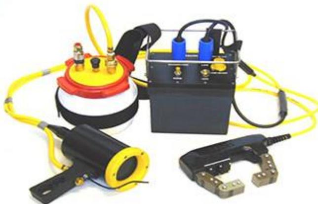
Slika 41. Podvodni sustav za kontrolu magnetskim česticama [43]
