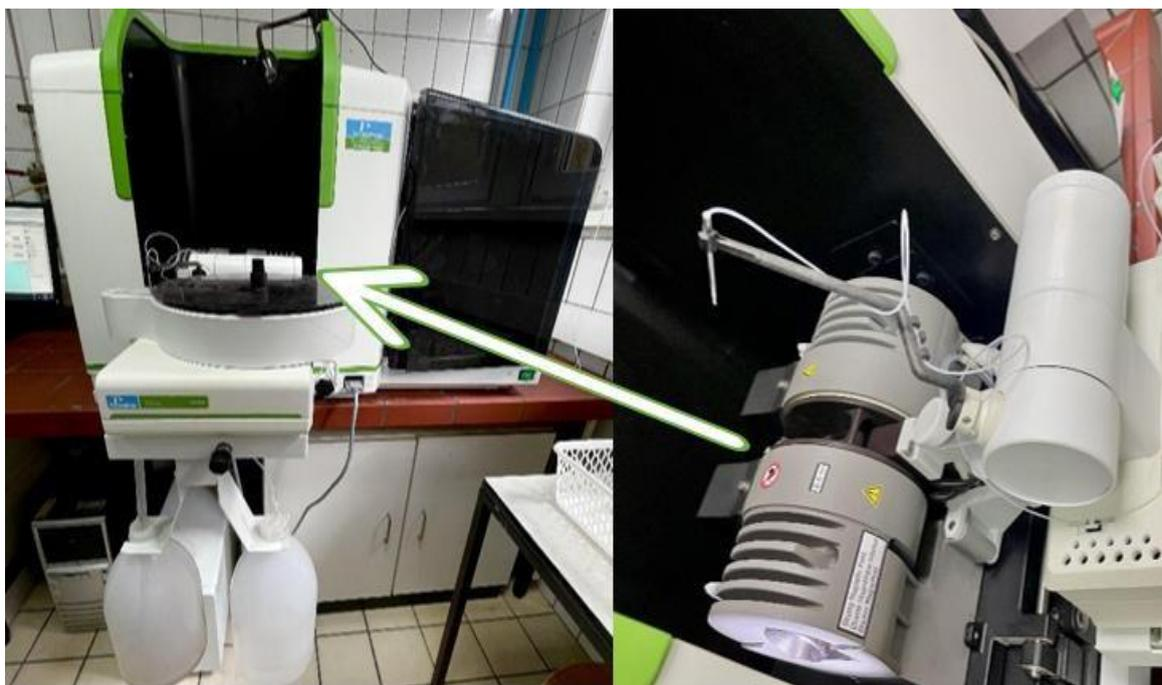
Slika br. 17 - Atomski apsorpcijski spektrofotometar PinAAcle 900Z – GFAAS
