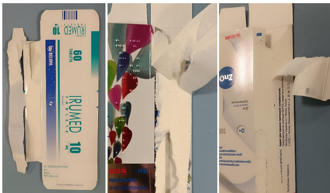
Slika 5.9 Ispitivanje lijepljenja analiziranih kartonskih kutija
