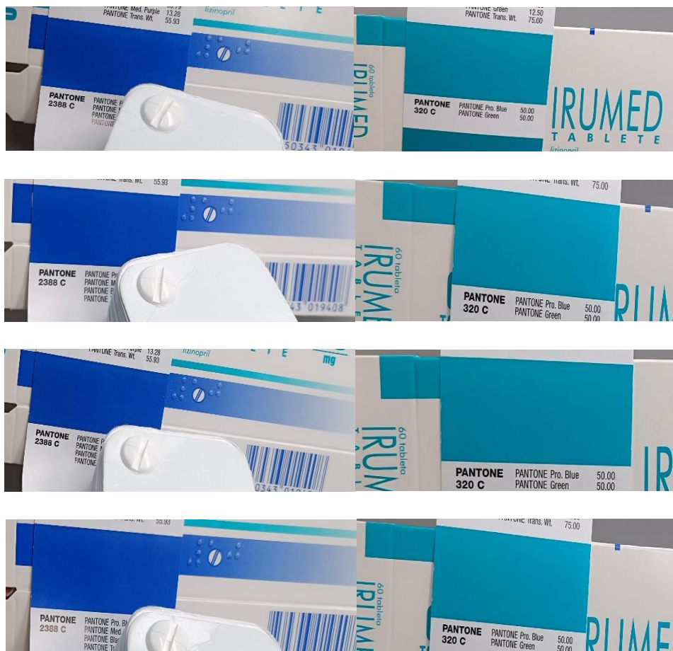
Slika 5.15 Vizualna kontrola Pantone 2388c i 320c prema Pantone katalogu
