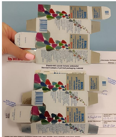
Slika 5.11 Vizualna kontrola boje pomoću ovjerenog standardnog uzorka
