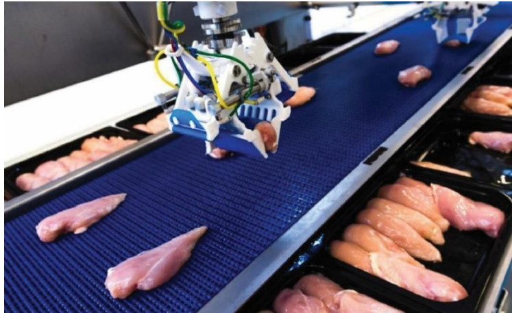
Slika 3.4. Robo Batcher hvataljka koja ima dijelove ispisane 3D pisačem
