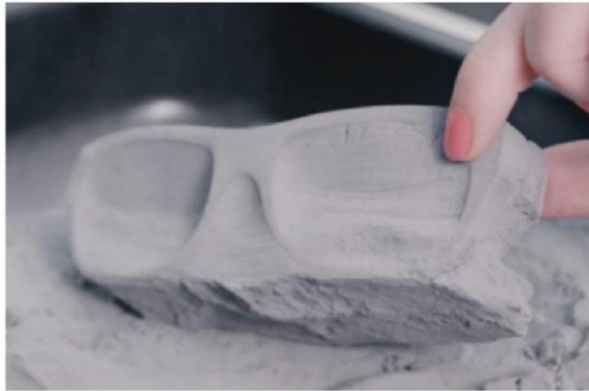
Slika 2.9. Model ispisan pomoću SLS tehnologije ispisa
