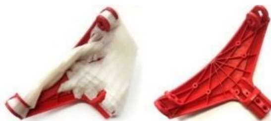
Slika 4.6. 3D model s potpornom strukturom te nakon što je ona uklonjena
