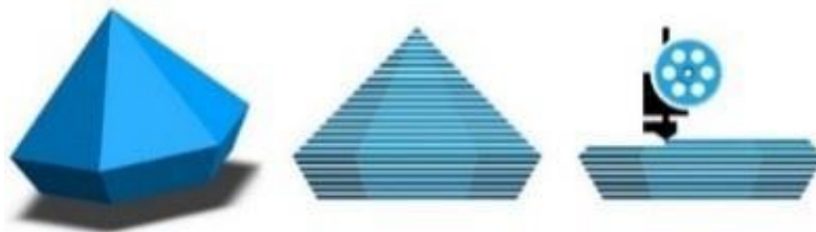
Slika 4.5. Postupak rezanja CAD 3D modela na slojeve
