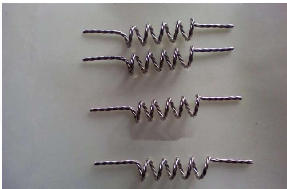
Slika 2.12. Prikaz Volframove niti, hrvatski izumitelj Franjo Hanaman
