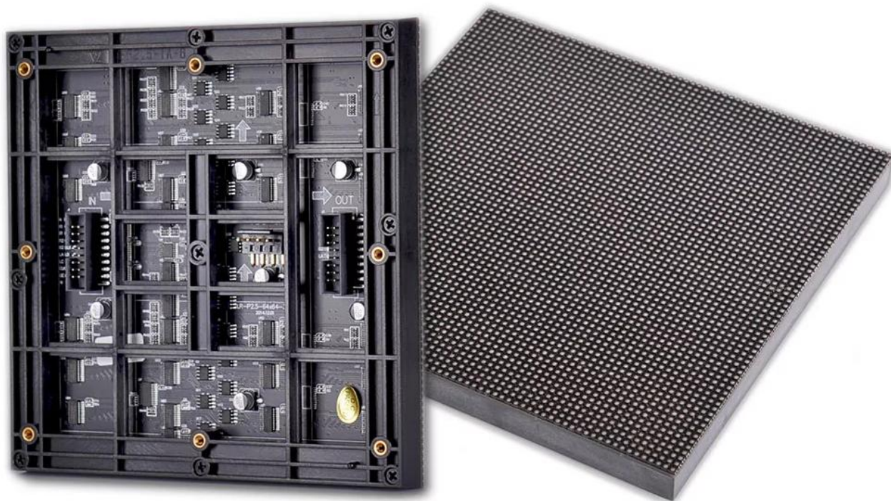
Slika 2.10. Prikaz LED panela veličine metra kvadratnog ( m^2 )
