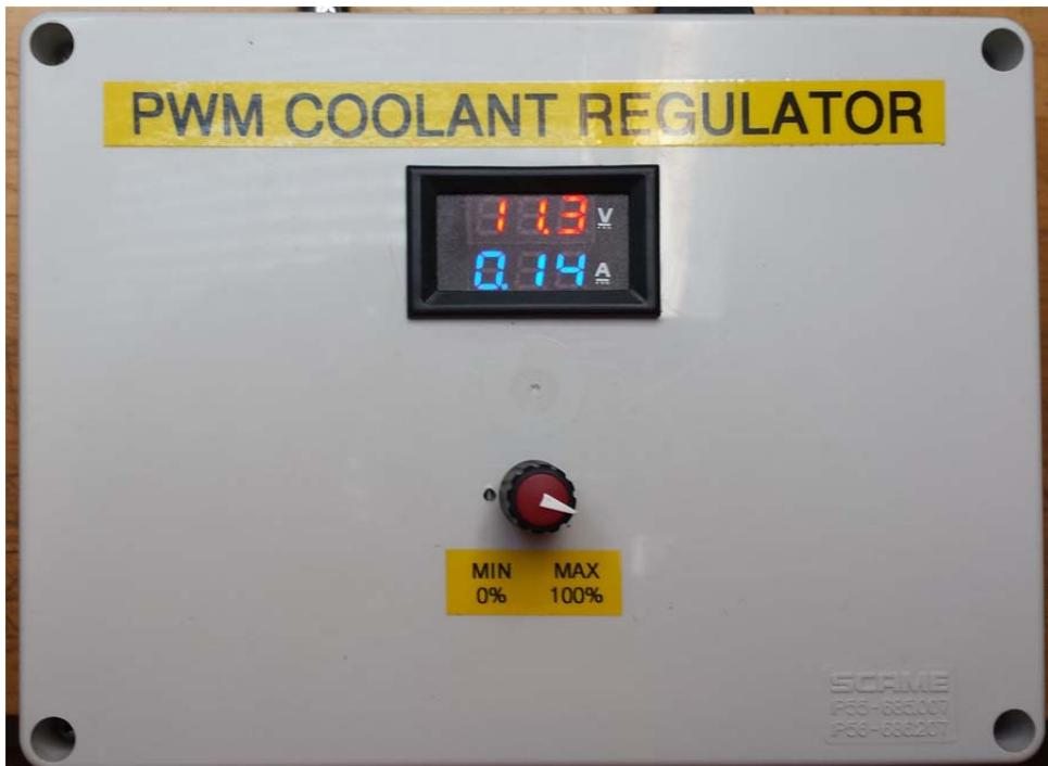
Slika 8: PWM regulator pumpe u plastičnom IP55 kućištu
