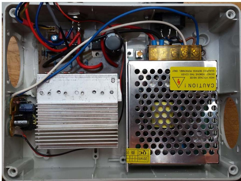
Slika 9: Dijelovi PWM regulatora pumpe
