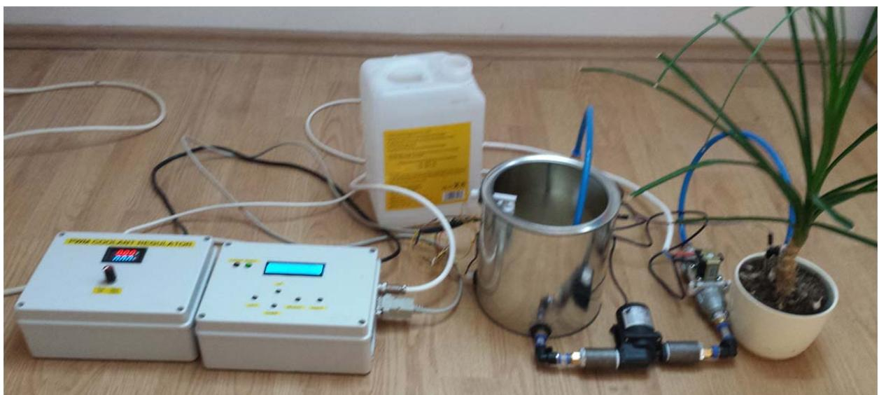
Slika 11: Maketa sustava za automatsko zalijevanje biljke
