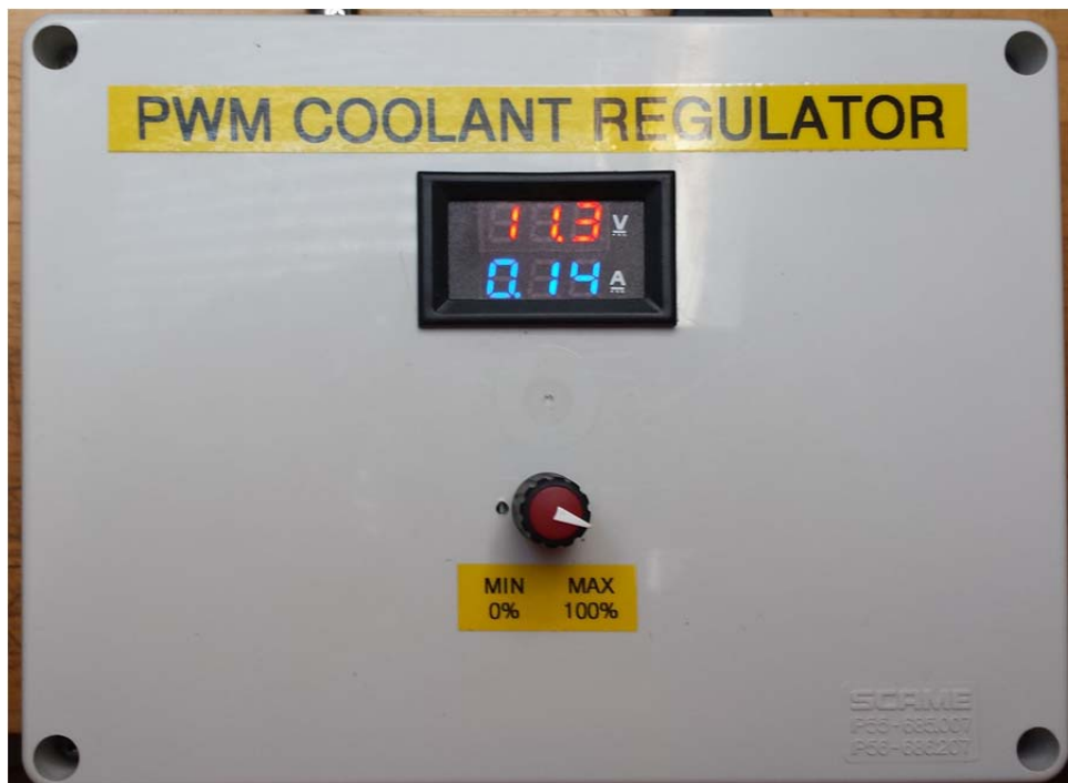
Slika 8: PWM regulator pumpe u plastičnom IP55 kućištu
