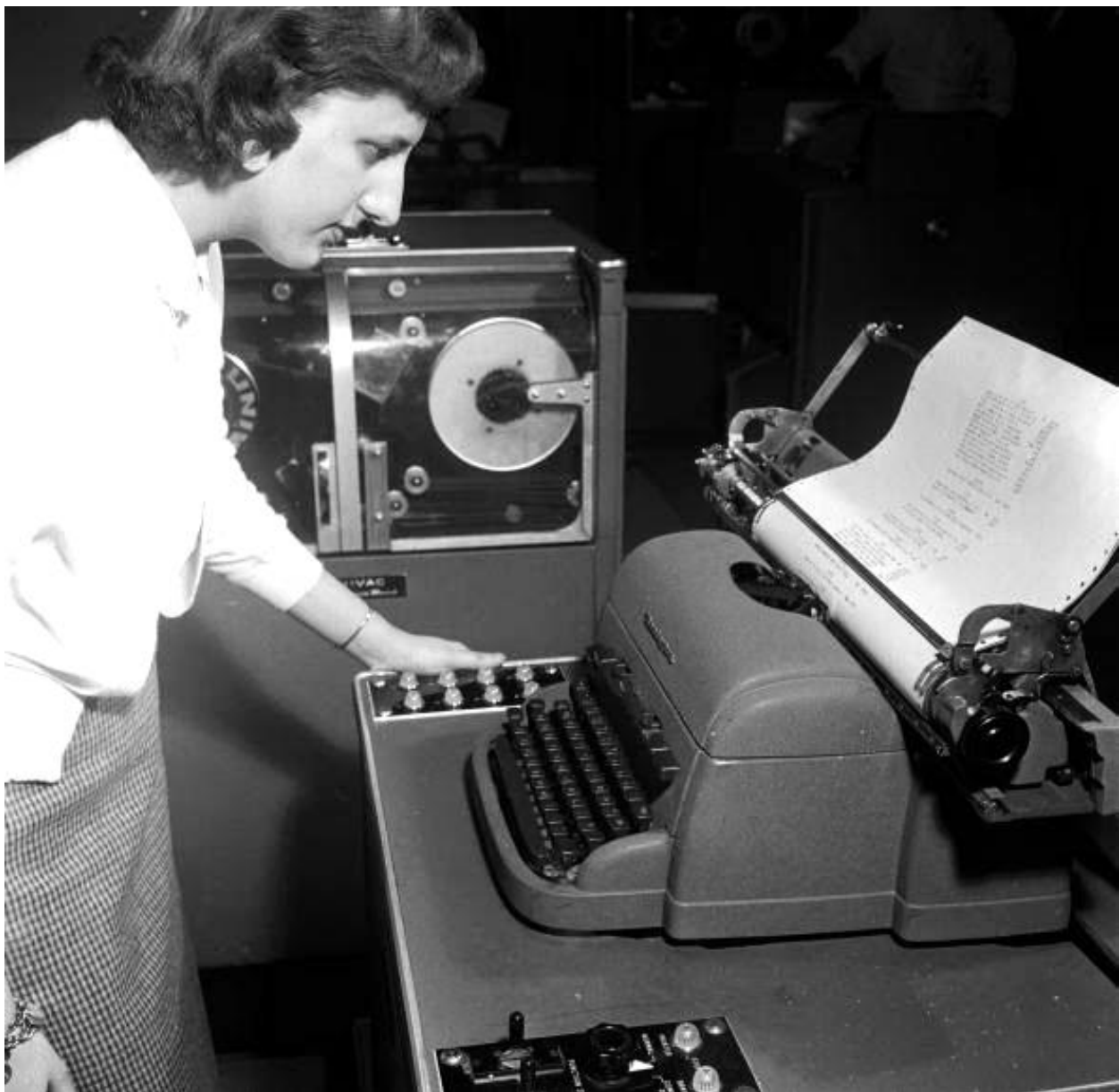
Slika 6: Operatorka čita sadržaj ispisani na UNIVAC I teleprinteru (Unityper)
