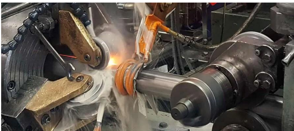
Slika 15. Visoko frekventno induksijsko zavarivanje [20]
