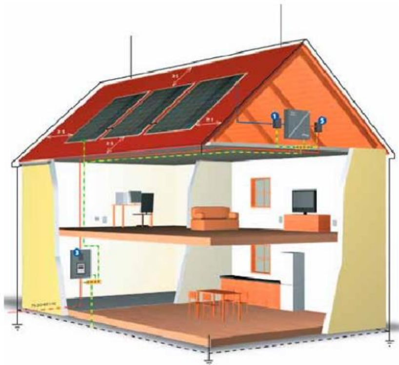
Slika 19. Gromobranska instalacija građevine [5].
