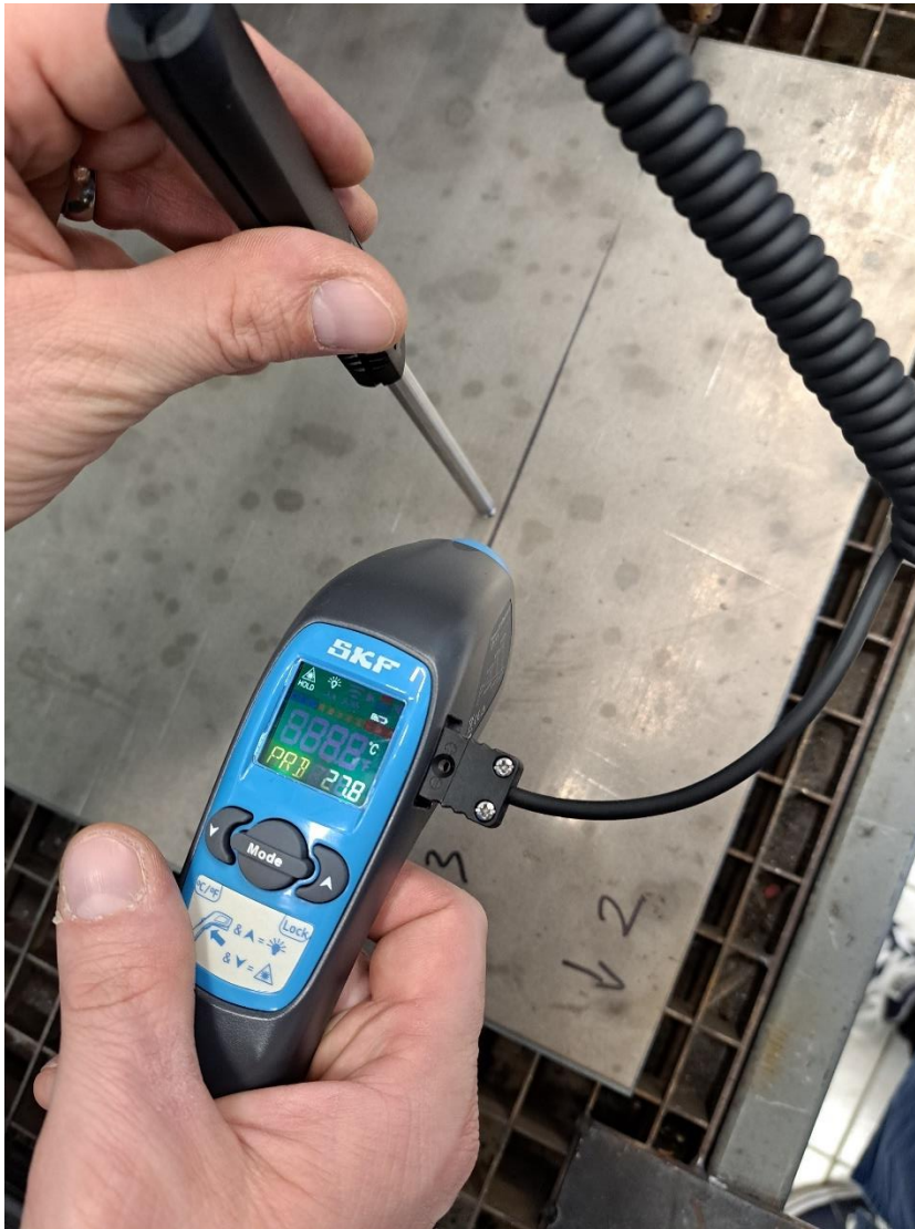
Slika 7.9 Provjera temperature materijala prije trećeg reza (fotografirano na Sveučilištu Sjever)
