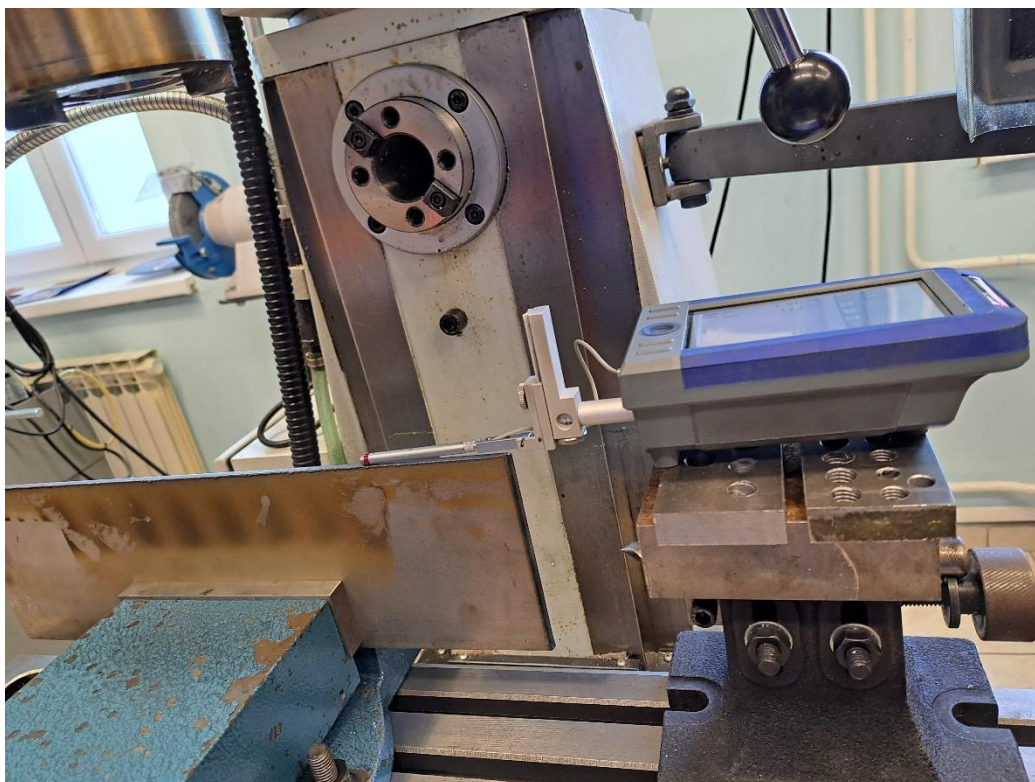
Slika 7.7 Uređaj za mjerenje hrapavosti AMETEK Taylor Hobson Surtronic S – 100 (fotografirano na Sveučilištu Sjever)
