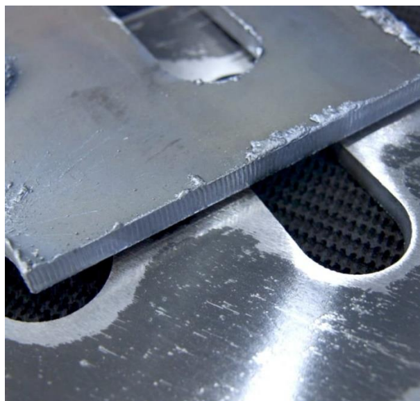
Slika 4.2 Izrezani segmenti prije i nakon uklanjanja troske [17]
