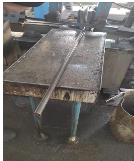
Slika 5.26 Rezanje sirovca (osobne slike)
