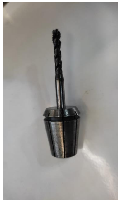
Slika 5.31 Urezник za izradu navoja (osobne slike)
