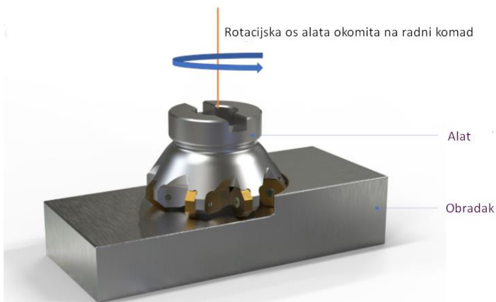
Slika 2.11 Prikaz čeonog glodanja [14]
