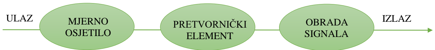
Slika 9 Struktura mjernog pretvornika
