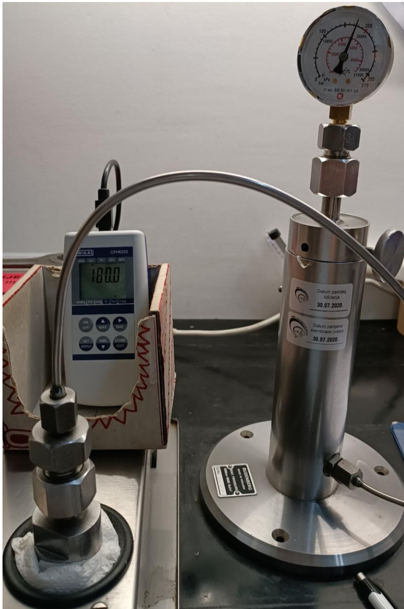
Slika 18 Umjeravanje mjerila u mjernom području 0/315 bar
