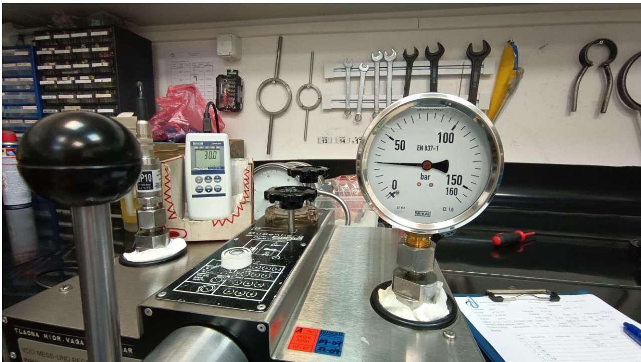
Slika 14 Umjeravanje mjerila u mjernom području 0/160 bar
