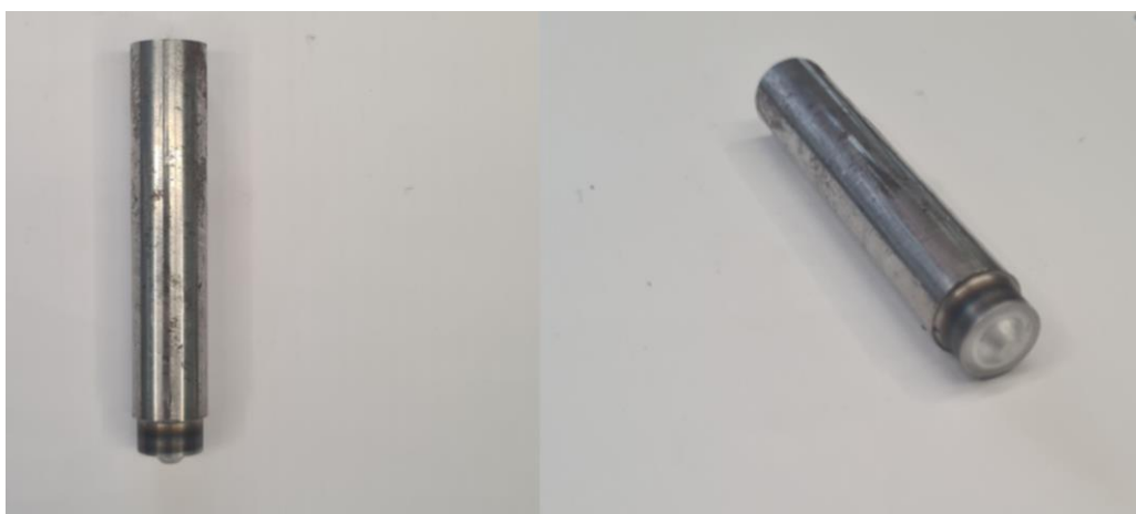
Slika 4.5 Alat za zavarivanje trenjem rotirajućim alatom korišten u eksperimentu
