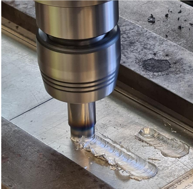
Slika 4.11 Kretanje FSW alata po putanji
