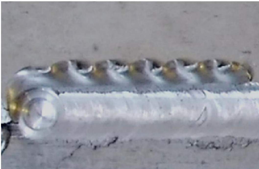
Slika 3.27 Zavar s prekomjerno istisnutim materijalom [19]
