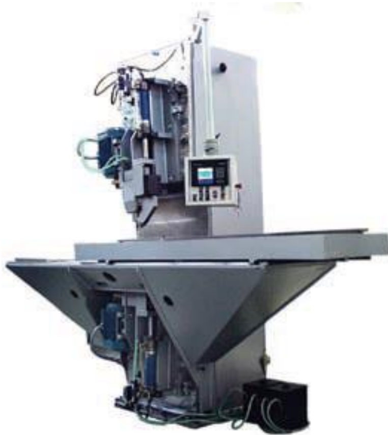
Slika 3.34 ESAB SuperStir™ jedinica [20]
