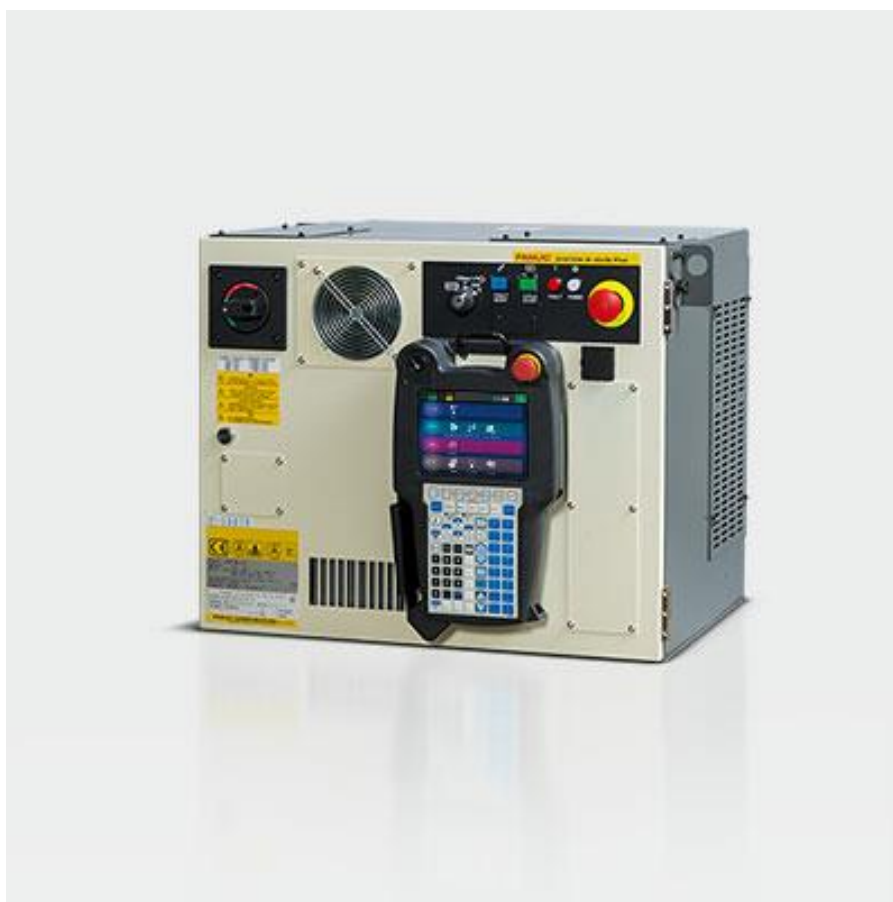
Slika 5.1. Prikaz R-30iB Plus robotskog kontrolera [21]
