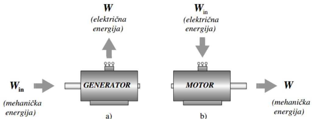
Slika 2.1 Tok energije u električnom stroju: a)generatoru, b)motoru [2]
