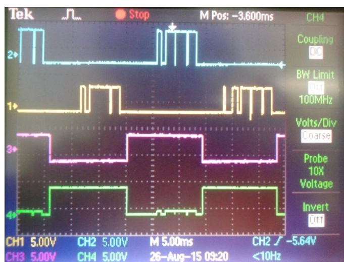
Slika 9.6 Valni oblici napona na gate driveru za svaki IGBT pri frekvenciji od 50Hz
