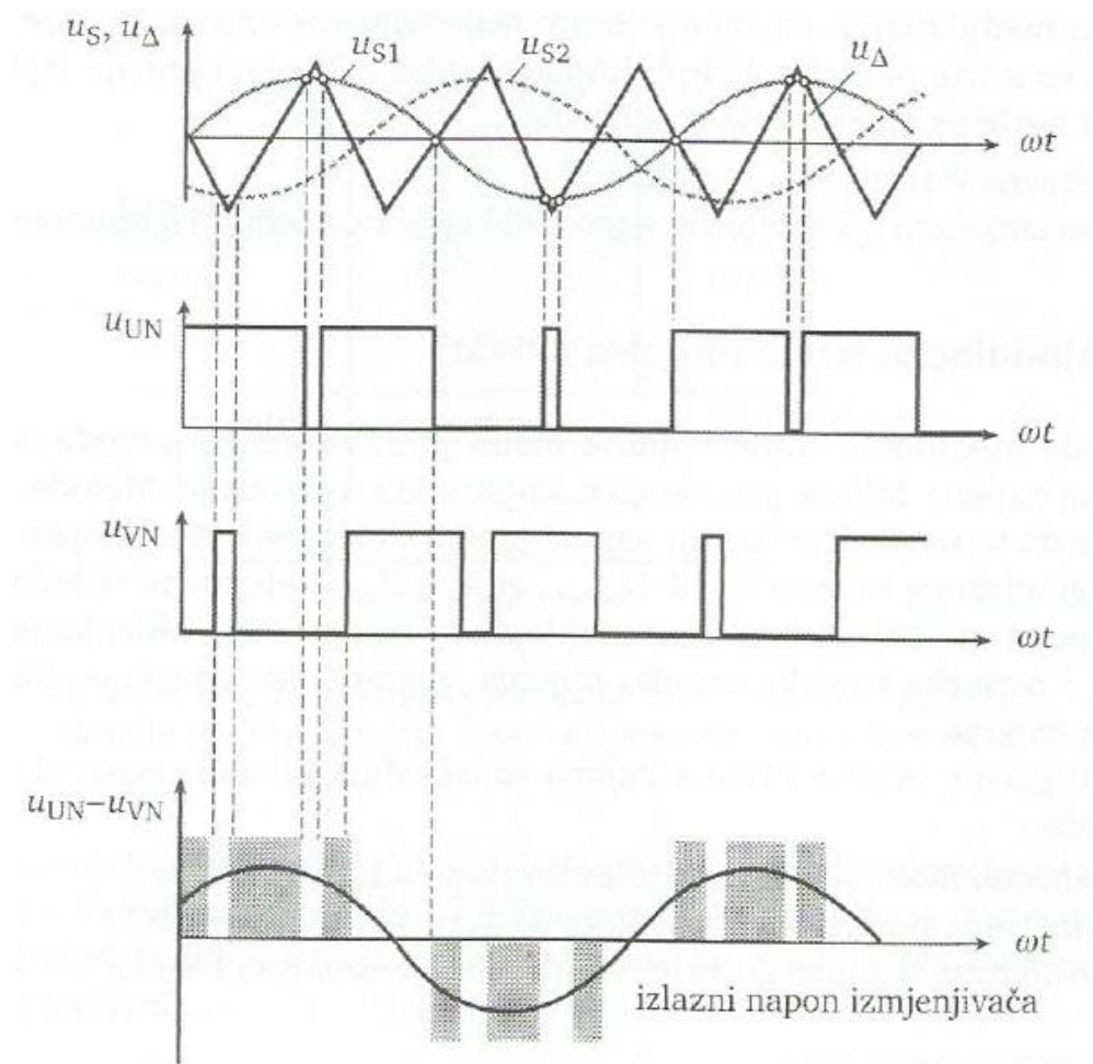
*Slika 7.3 Sinusna modulacija na temelju dva sinusna signala, dobivanje linijskog napona [1]*
