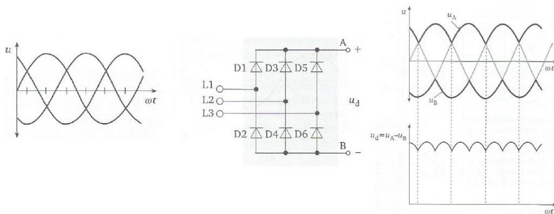
Slika 6.5 Punovalni trofazni diodni ispravljač u mosnom spoju [1]
