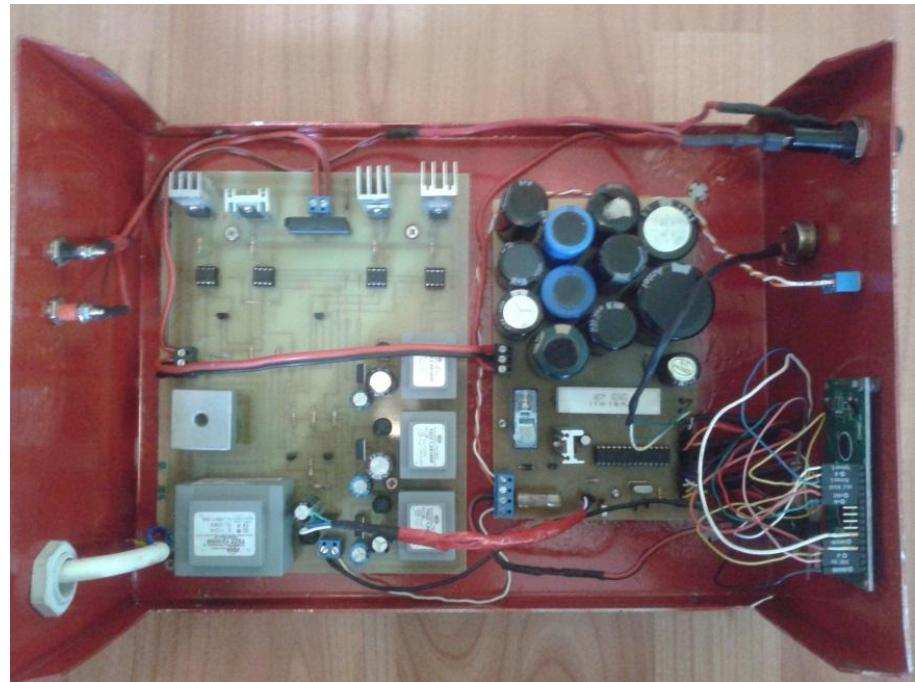
Slika 8.14 Unutrašnjost uređaja
