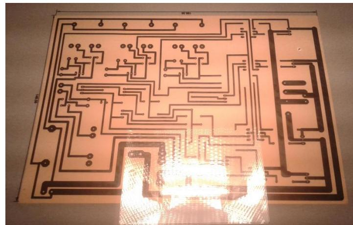
*Slika 8.11 Osvjetljavanje pločice*
