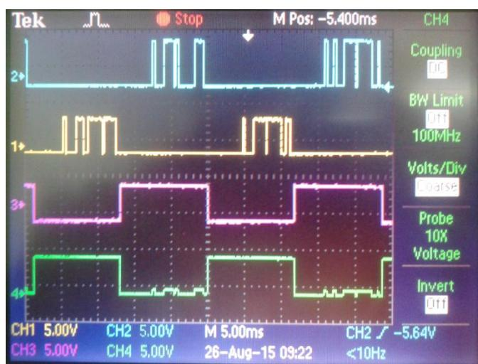
Slika 9.9 Valni oblici napona na gate driveru za svaki IGBT pri frekvenciji od 65Hz
