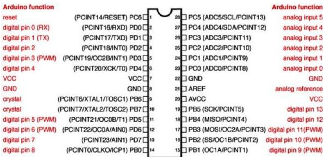
Slika 8.4 Izvedba mikrokontrolera ATMEGA 328 s rasporedom pinova[4]
