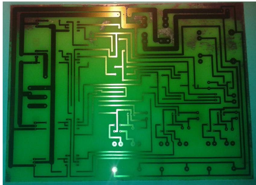
Slika 8.13 Jetkanje pločice
