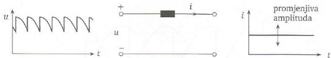
Slika 6.7 Strujni istosmjerni medukrug s valnim oblicima napona i struje[1]
