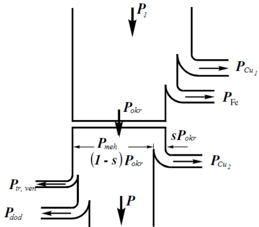
Slika 4.4 Bilanca snage asinkronog stroja [2]
