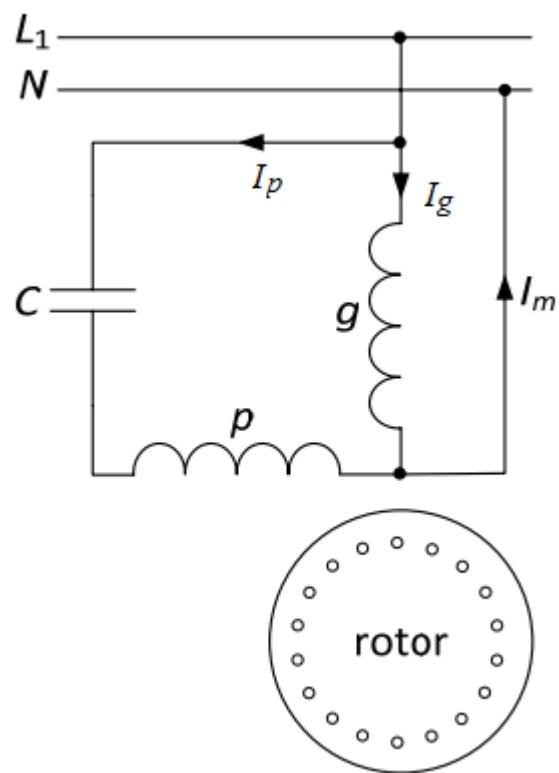
Slika 4.1 Način priključivanja jednofaznog asinkronog stroja na mrežu[2]
