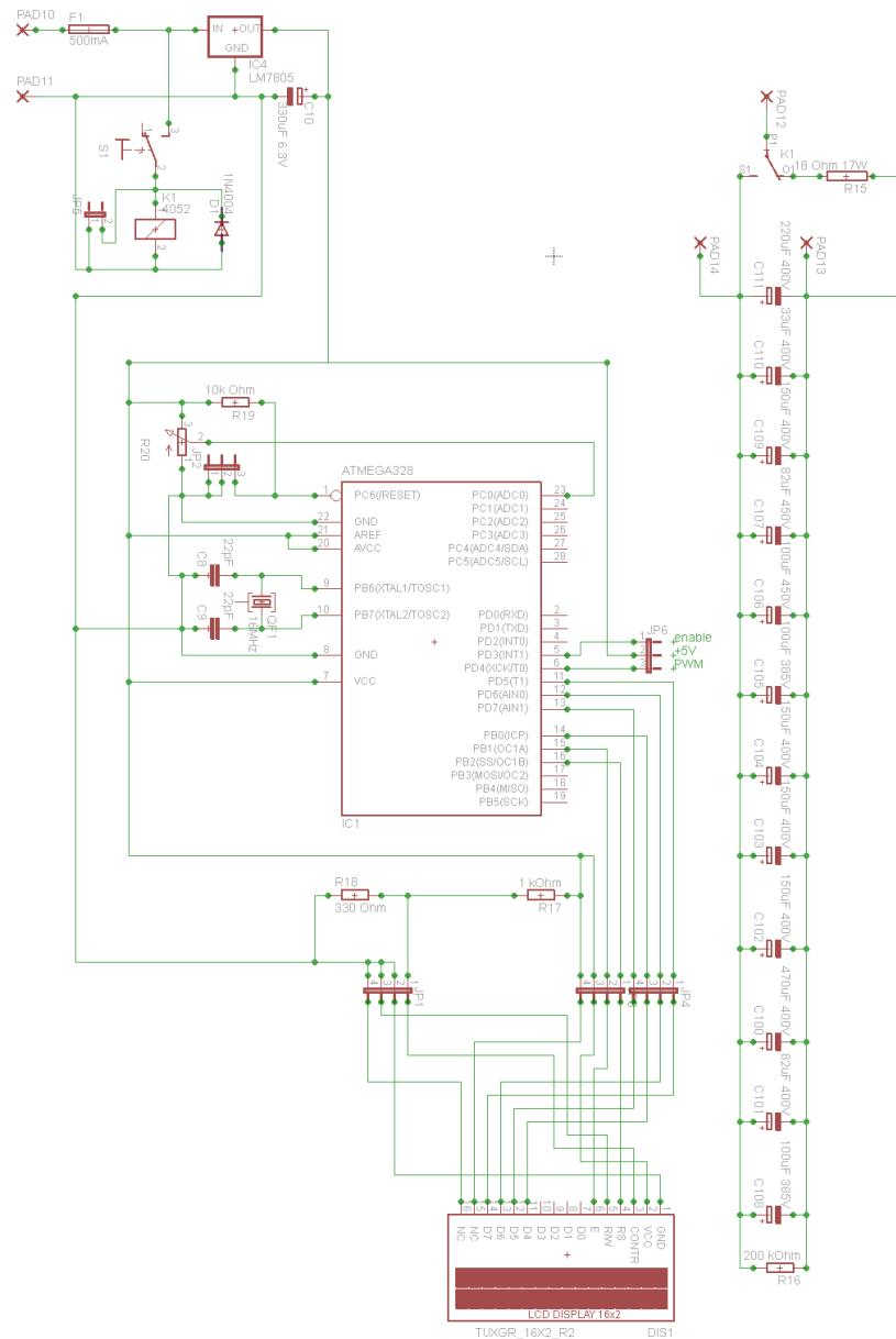
*Slika 8.1 Shema upravljačkog sklopa, mikrokontrolera, istosmernog međukruga s kondenzatorima i kočionim otpornikom.*
