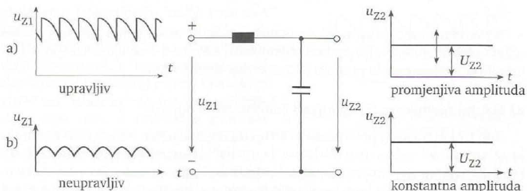
Slika 6.8 Naponski istosmjerni međukrug s a) promjenjivim i b) konstantnim naponom napajanja [1]
