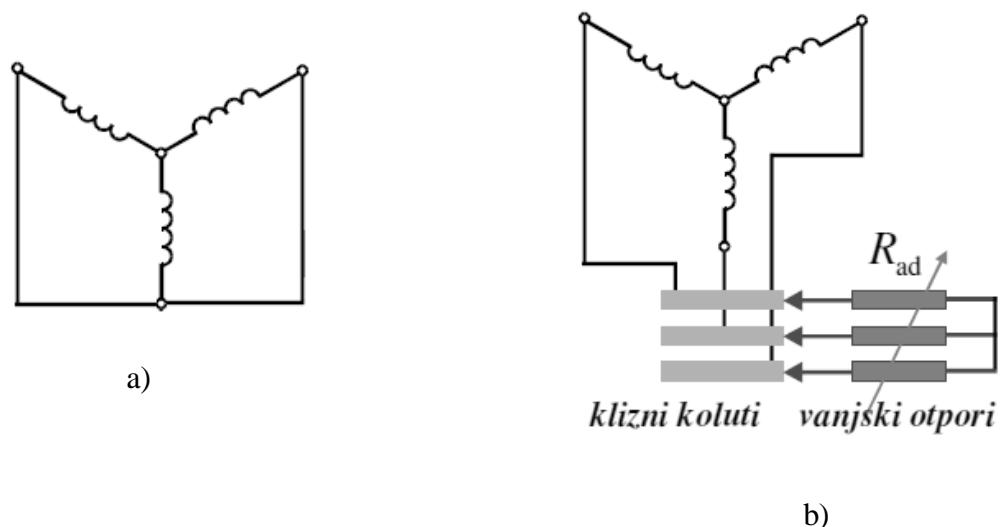
Slika 4.2 Nadomjesna shema rotora: a) kavezni, b) kolutnog [2]
