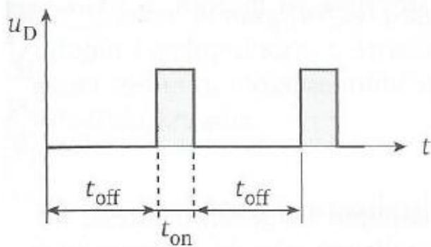
Slika 6.10 Valni oblik napona na porednoj diodi [1]
