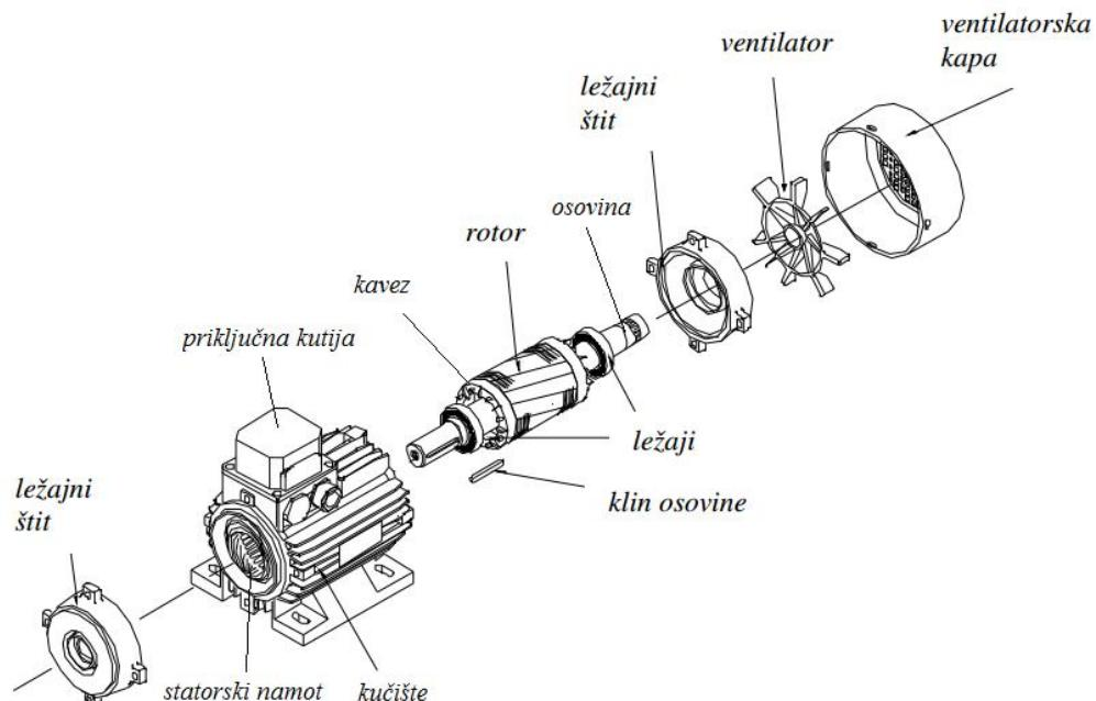
Slika 2.2 Osnovni dijelovi asinkronog stroja [2]
