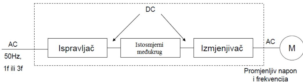
Slika 6.4 Blok shema neizravnog frekvencijskog pretvarača[3]
