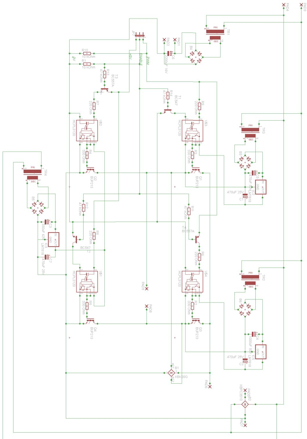
Slika 8.2 Shema ispravljača i izmenjivača s logikom upravljanja izmenjivačem.
