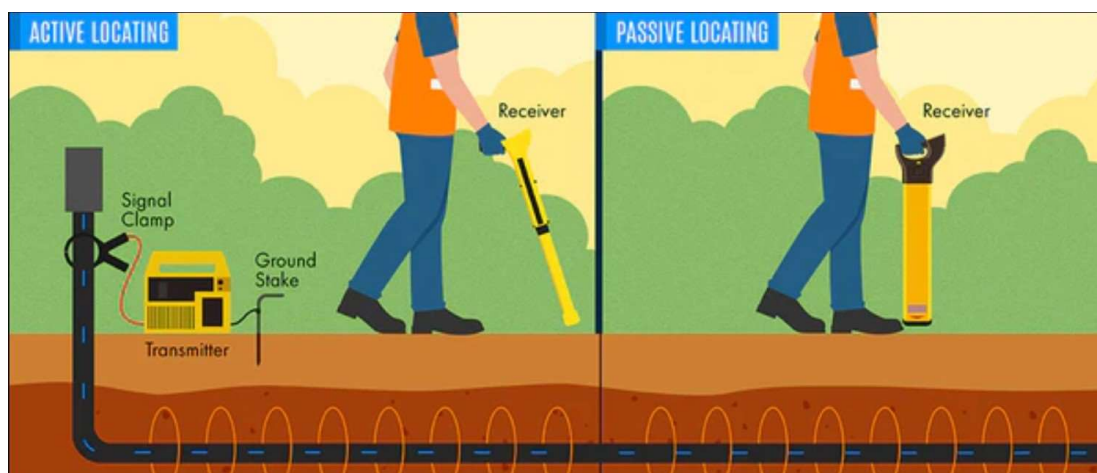
Slika 4.6: Prikaz razlike aktivnog i pasivnog lociranja vodova
