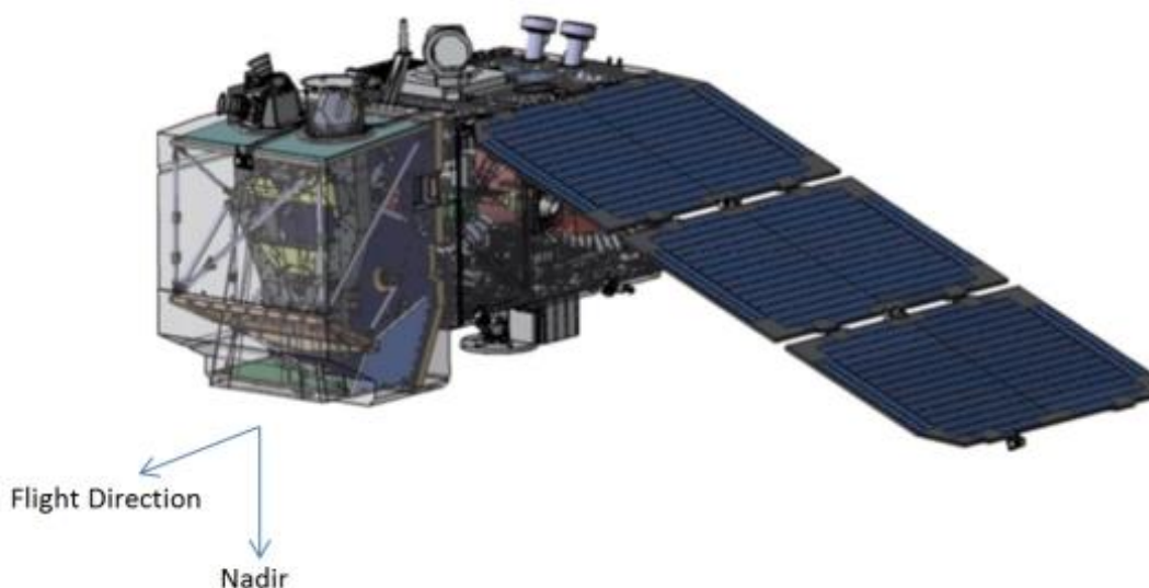
Slika 2.2. Shematski prikaz Sentinel-2 satelita [18]
