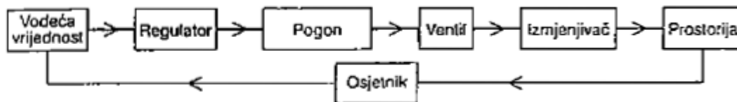
Slika 3.1 Osnovni elementi regulacijskog kruga [15]
