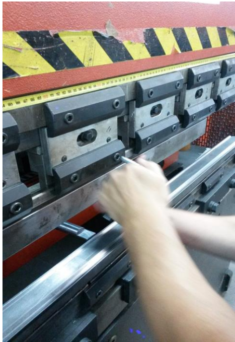
Slika 7.1 Otpuštanje vijaka imbus ključem
