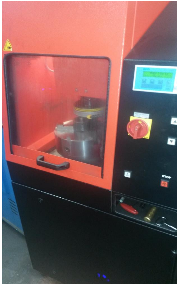
Slika 6.9 Brušenje matrice na CNC brusilici
