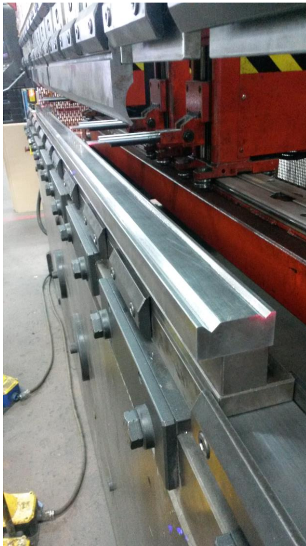
Slika 7.3 Prikaz matrice i alata za savijanje
