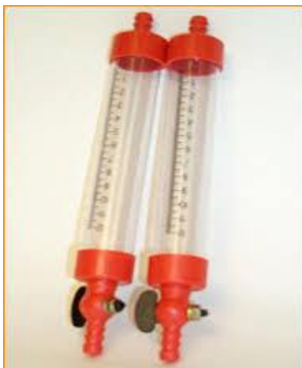
Slika 4. Hidrostatski nivelman metoda temeljena na gumenim cijevima
