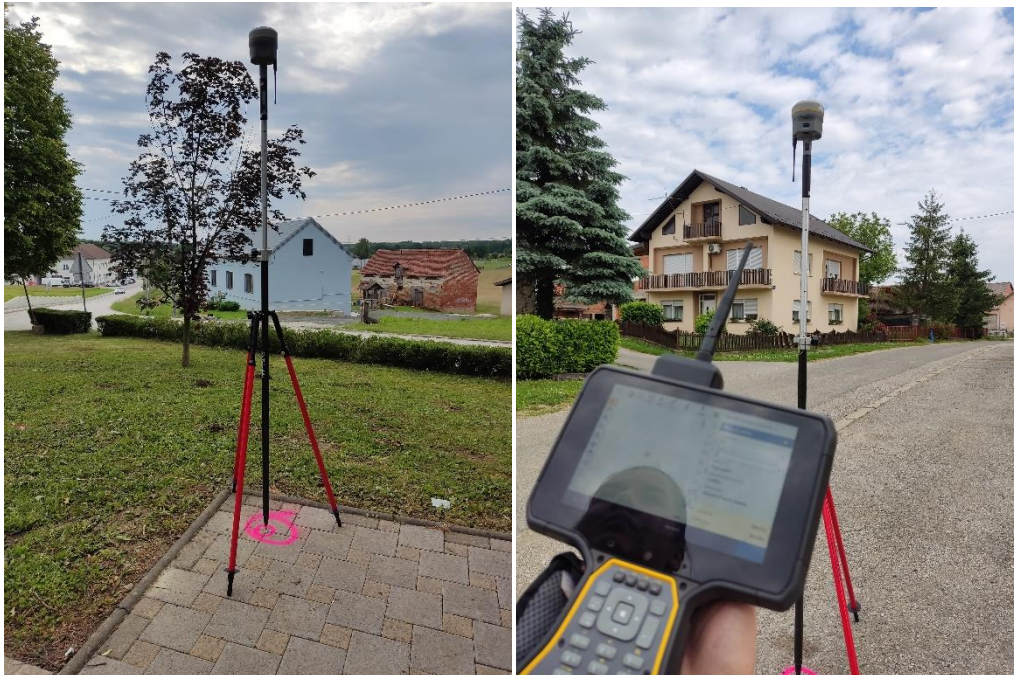
Slika 17. Signalizacija točaka u Rakovcu pomoću prizme i tronošca
