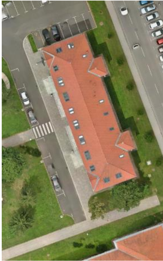
Slika 14. DOF iz kombinacije vertikalnih i kosih snimki
