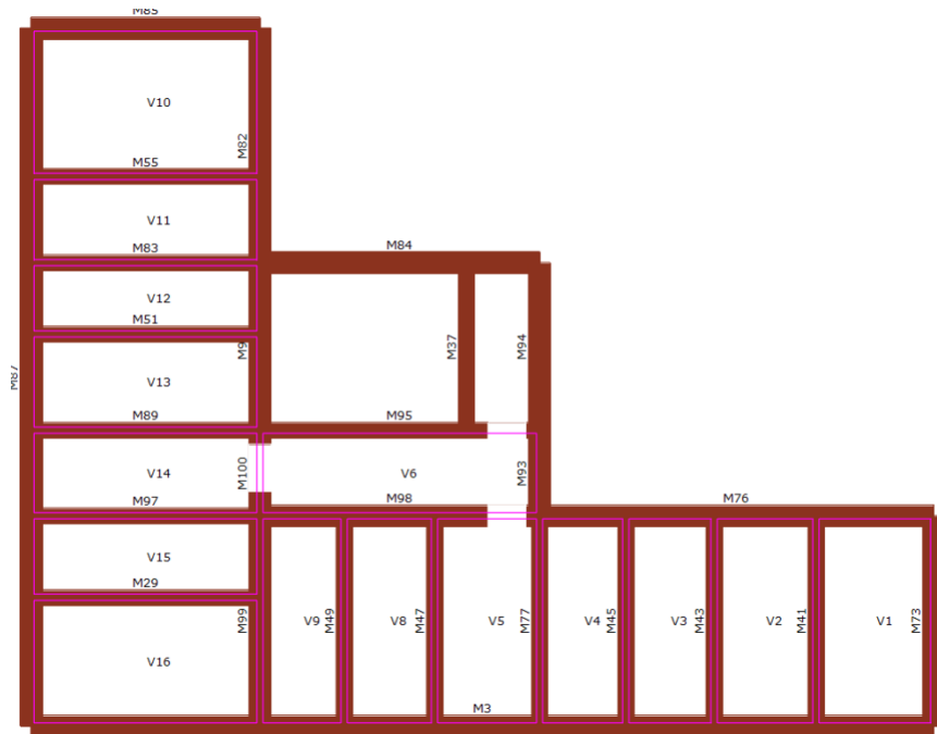
Slika 8.2 Tlocrt podrum (grafički prikaz razine iz programa 3Muri)
