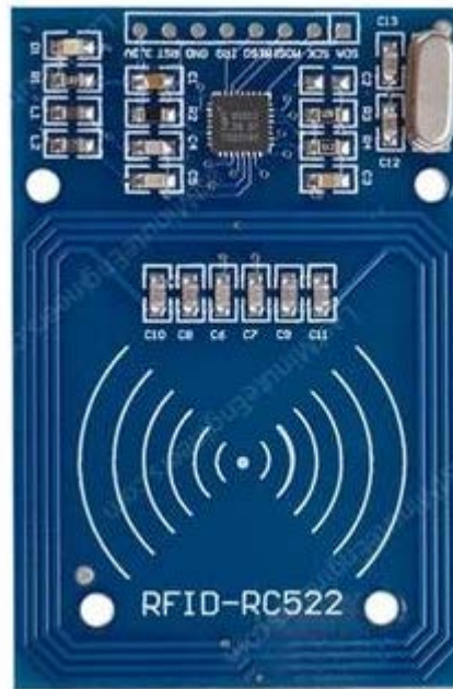
Slika 4.4 RFID RC522 modul [4]
