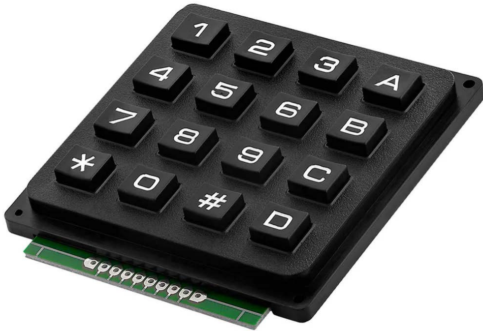
Slika 4.8 Matrična tipkovnica 4x4 [7]
