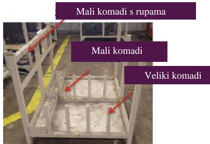
Slika 21. Specijalne palete za dijelove postolja dizalice za kamione (LKW ), Palfinger d.o.o., Delnice
