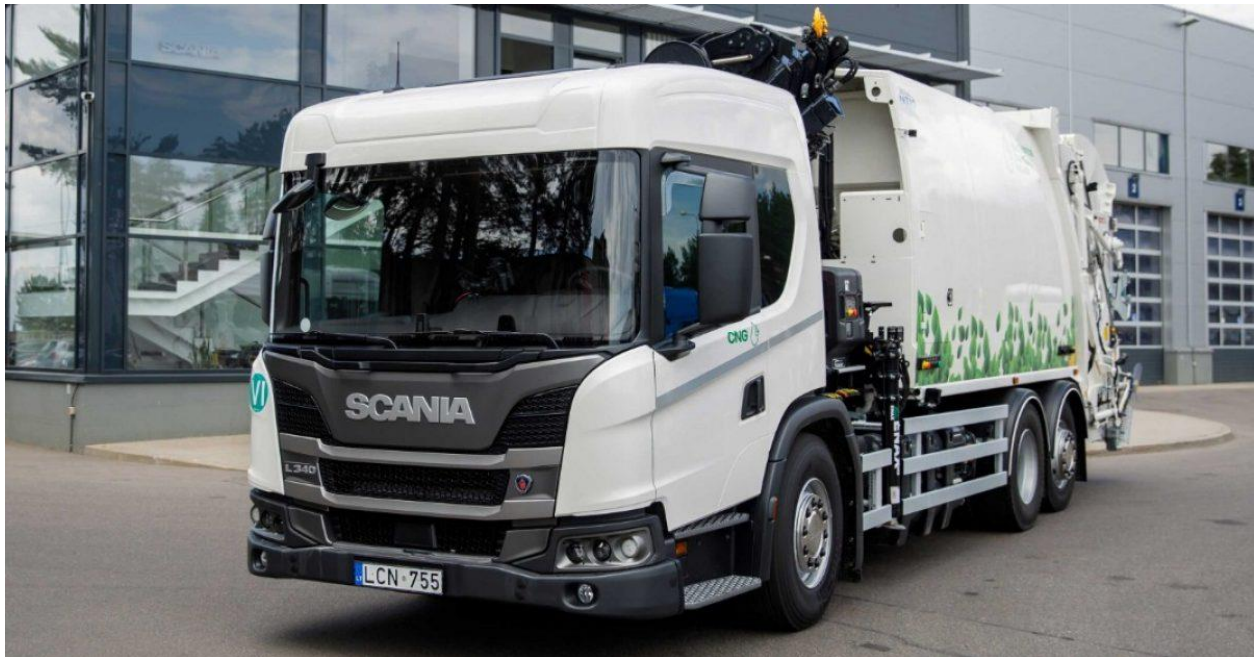
Slika 30 Scania L serije sa komunalnom nadogradnjom
