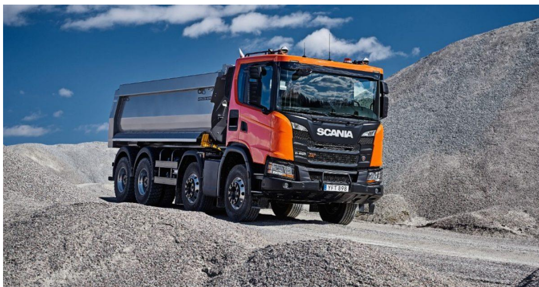
Slika 35 Scania serije XT sa nadogradnjom dampera
