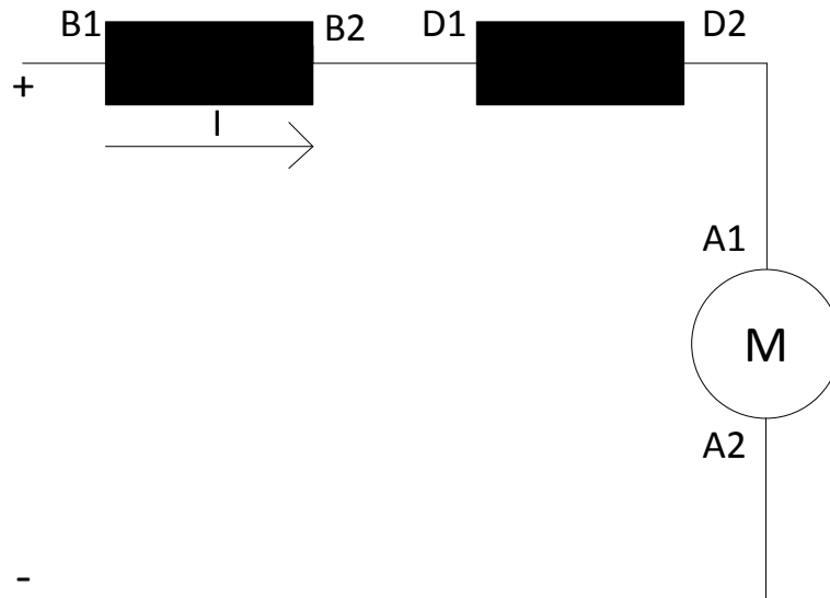
Slika 2.6 Shema istosmjernog motora sa serijskom uzbudom
