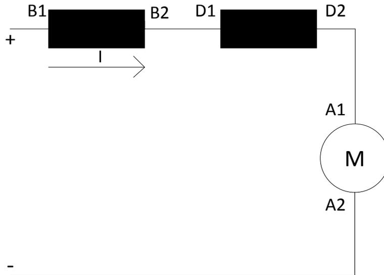
Slika 2.6 Shema istosmjernog motora sa serijskom uzbudom
