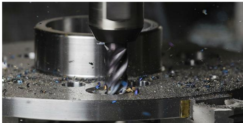
Slika 1. Prikaz procesa glodanja [5]
