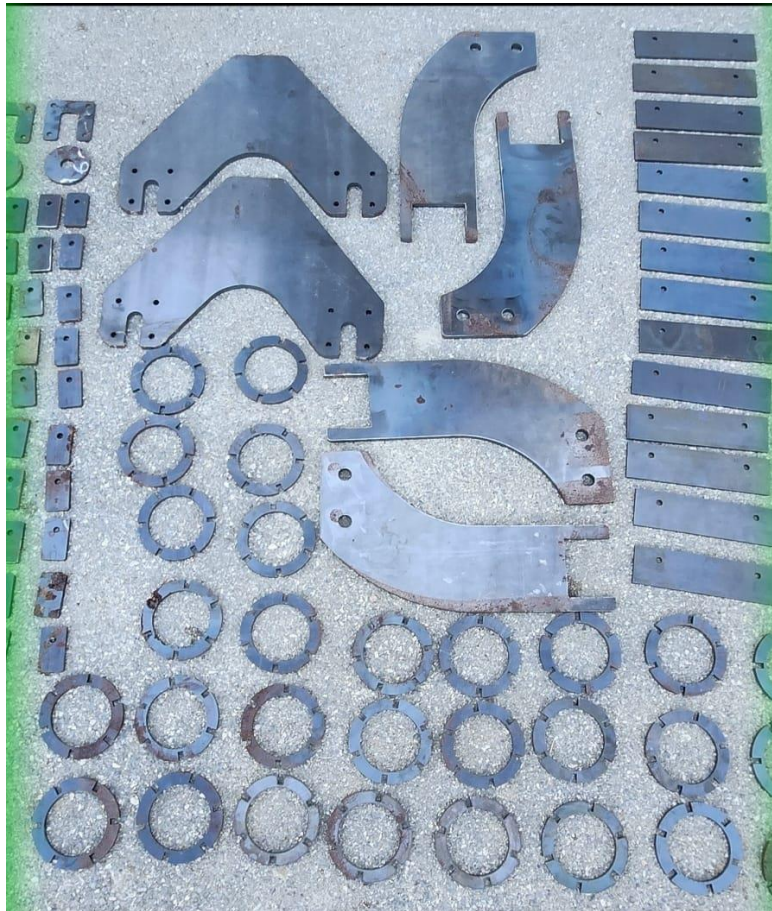
Slika 7.3. Dio elemenata rezanih „fiber“ laserom
