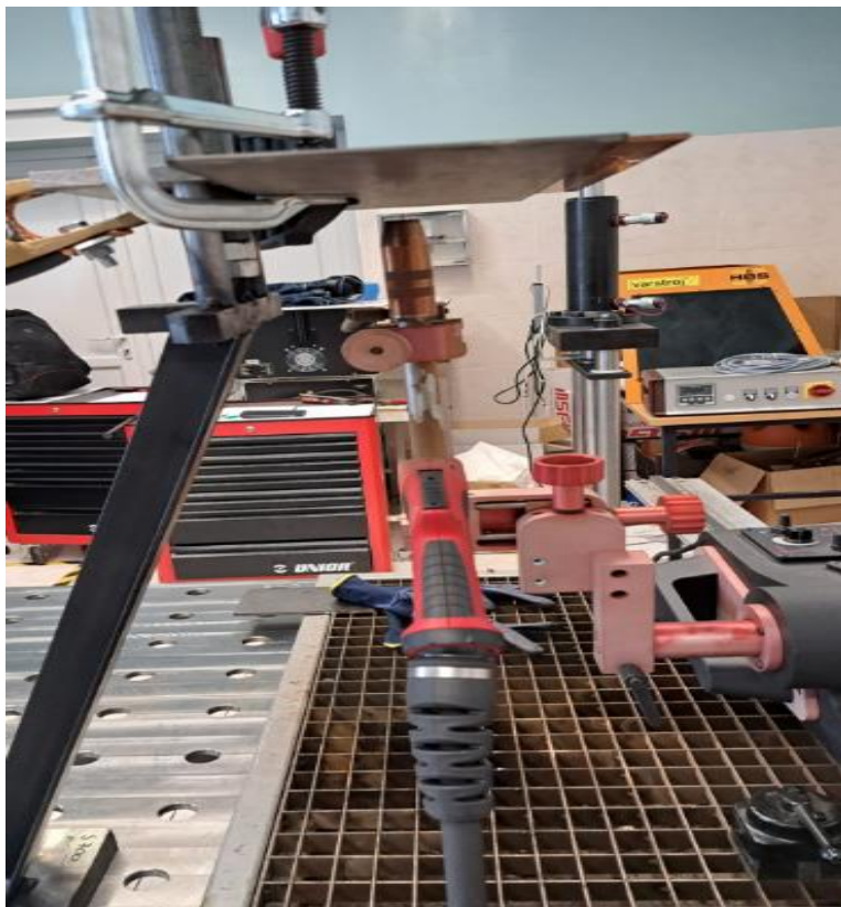
Slika 37 Pištolj postavljen u početnoj točki u PE položaju
