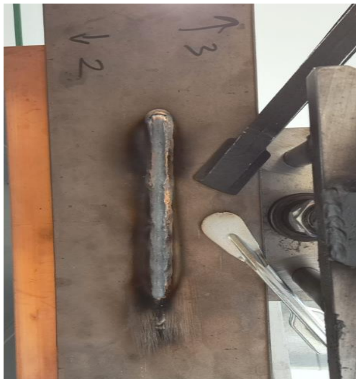
Slika 38 Prvi sloj navara u PE položaju ( I=180\text{ A} ; v=36\text{cm/min} ; z=4,5\text{ mm} )
