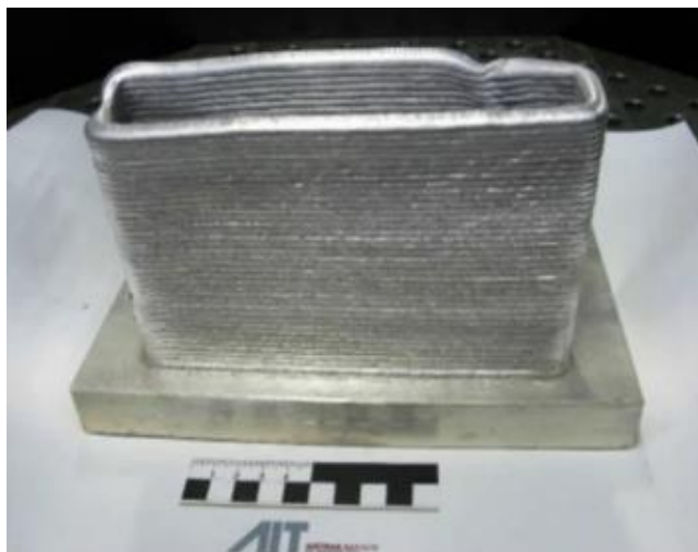
Slika 12 Uzorak magnezijeve legure izrađene WAAM-om [16]
