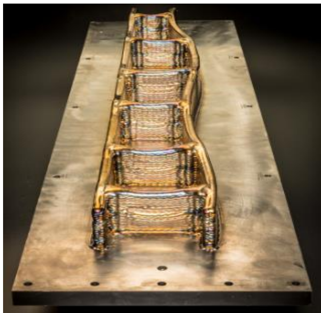
Slika 13 Potporna konstrukcija krila zrakoplova [20]
