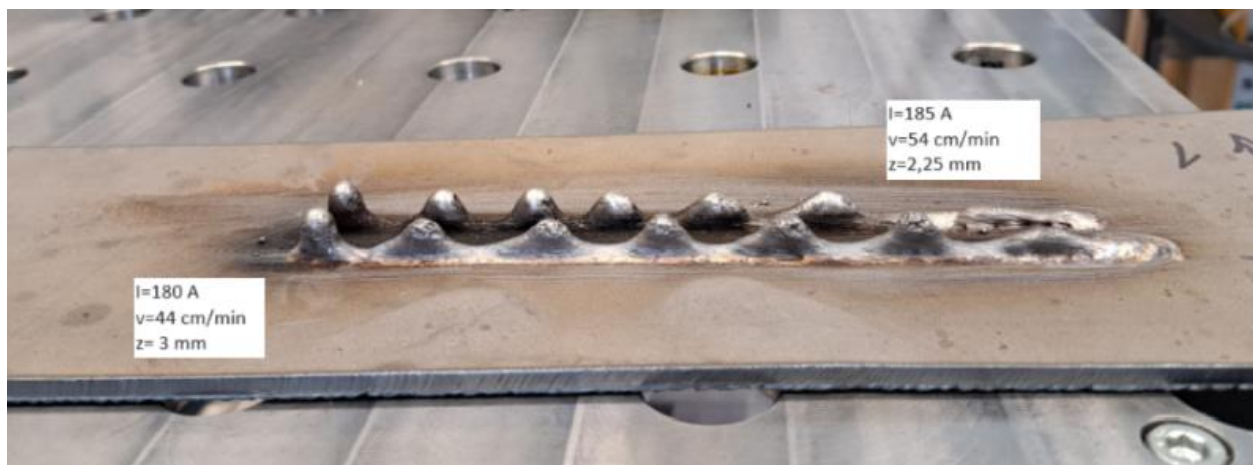
Slika 43 Drugi sloj navara u PE položaju
