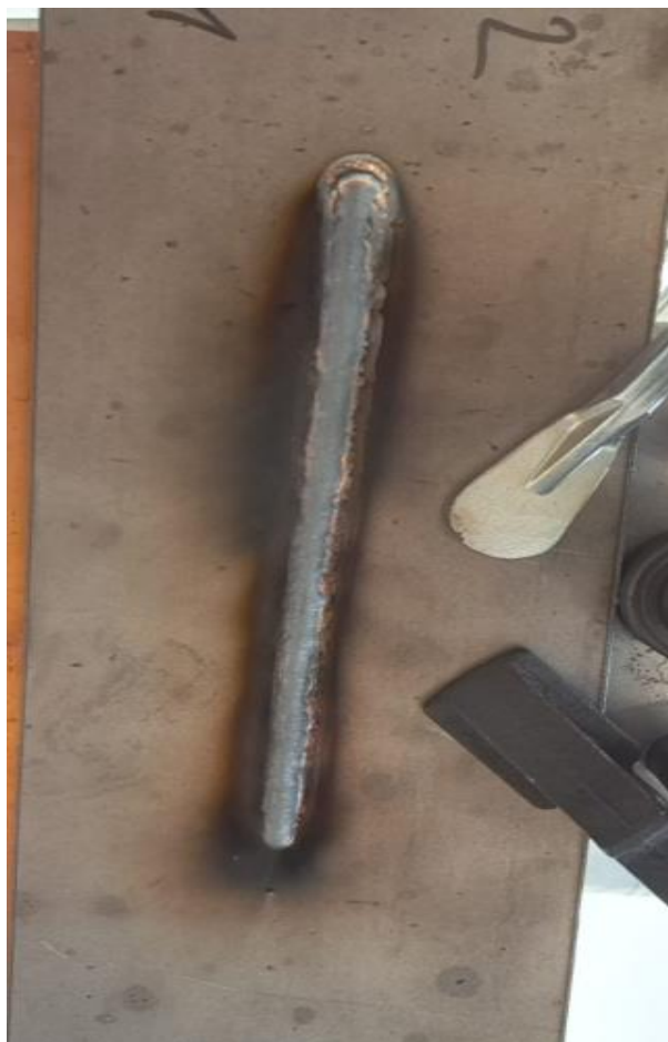
Slika 41 Prvi sloj navara u PE položaju ( I=180 A; v=36 cm/min; z=4,5 mm)
