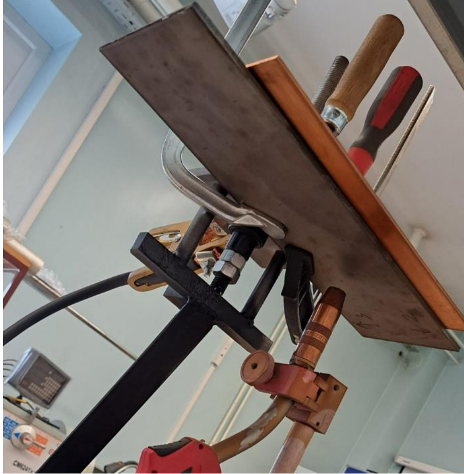
Slika 30 PE položaj zavarivanja
