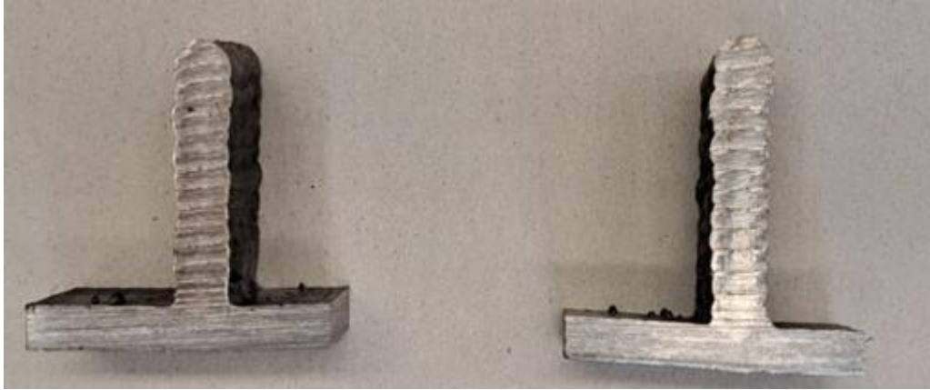
Slika 47 Površina uzorka nakon obrade rezanja navarenog strujom jakosti 180 A (lijevo) i 190 A (desno)
