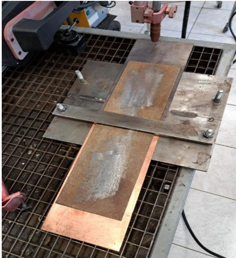
Slika 29 PA položaj zavarivanja
