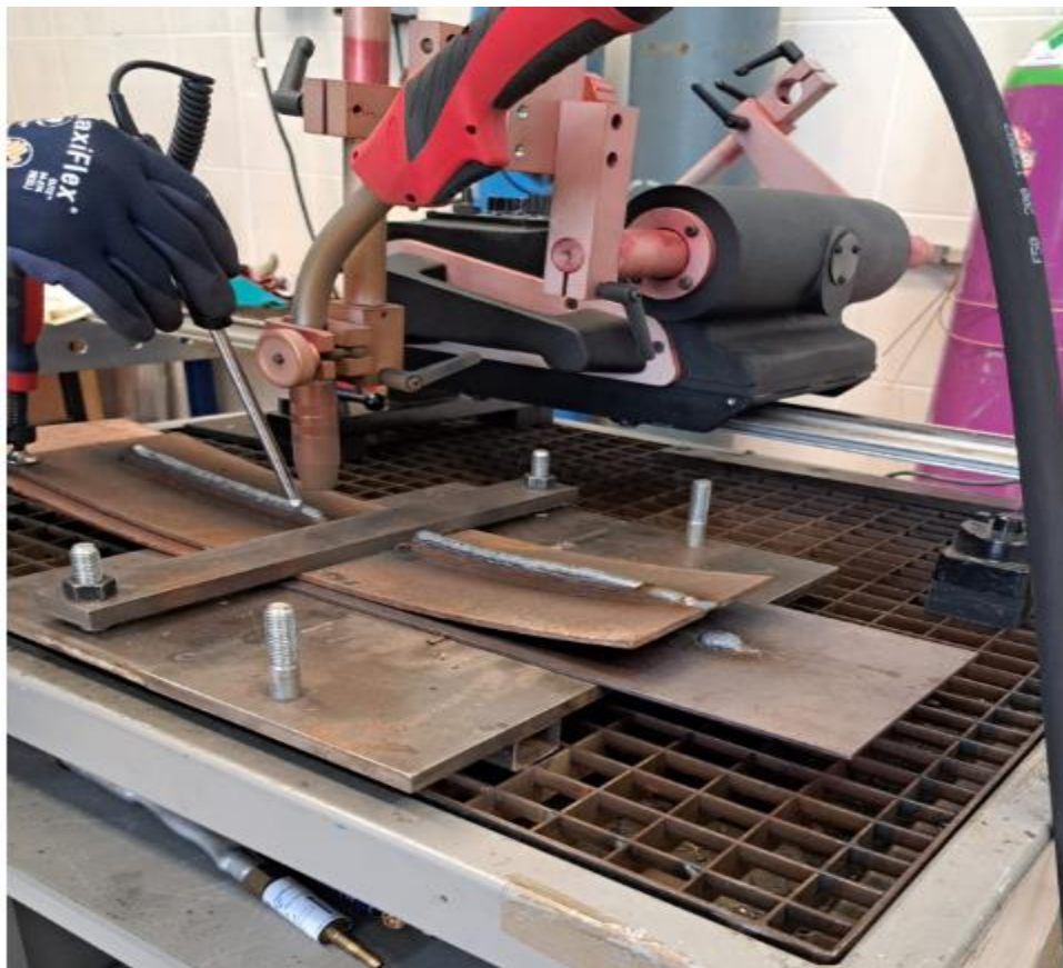
Slika 34 Savijanje podloge za navarivanje
