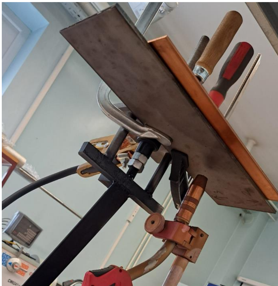
Slika 30 PE položaj zavarivanja
