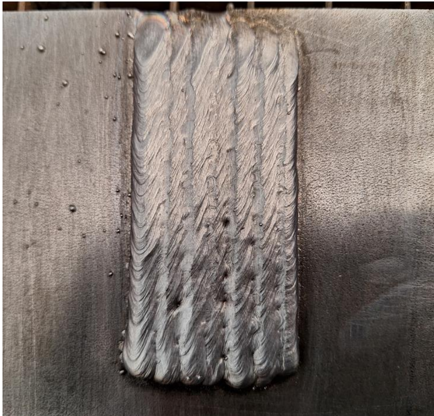
Slika 49 – Detaljni pogled sloja nehrđajućeg čelika navarenog s jakosti struje navarivanja 170 A (gore) i sloja navarenog s jakosti struje navarivanja 190 A (dolje)
