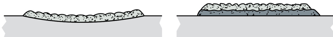
Slika 27 – Shematski prikaz zgnječenja navarenog sloja u OM (lijevo) te primjena prijelaznog sloja niskolegiranog ili srednjolegiranog čelika za sprječavanje zgnječenja (desno) [5]
