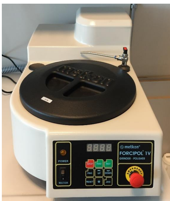
Slika 37 – Uređaj za brušenje i poliranje Metkon Forcipol 1V Grinder & Polisher [36]
