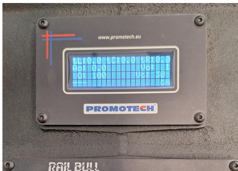
Slika 44 – Brzina navarivanja i pozicija navarivanja prvog prolaza uneseni u automat za precizno vođenje pištolja Promotech Rail Bull
