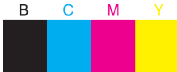
Slika 17. Mjerna polja za određivanje gustoće obojenja
