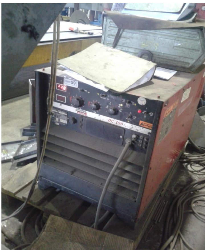
Slika 6.1 Izvor struje za zavarivanje[9]
