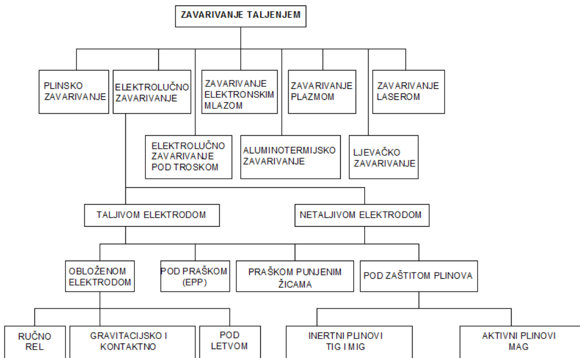
Slika 1.2 Podjela postupaka zavarivanja taljenjem[11]
