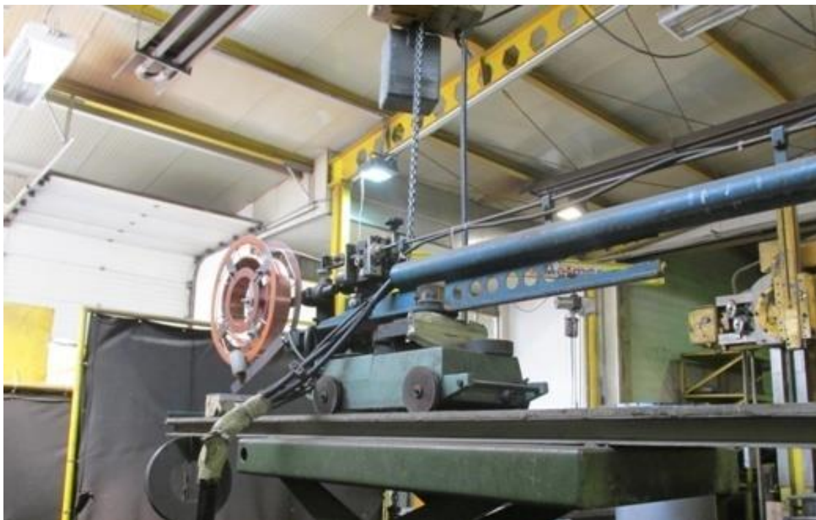
Slika 6.6 Vodenje žice za EPP zavarivanje[9]
