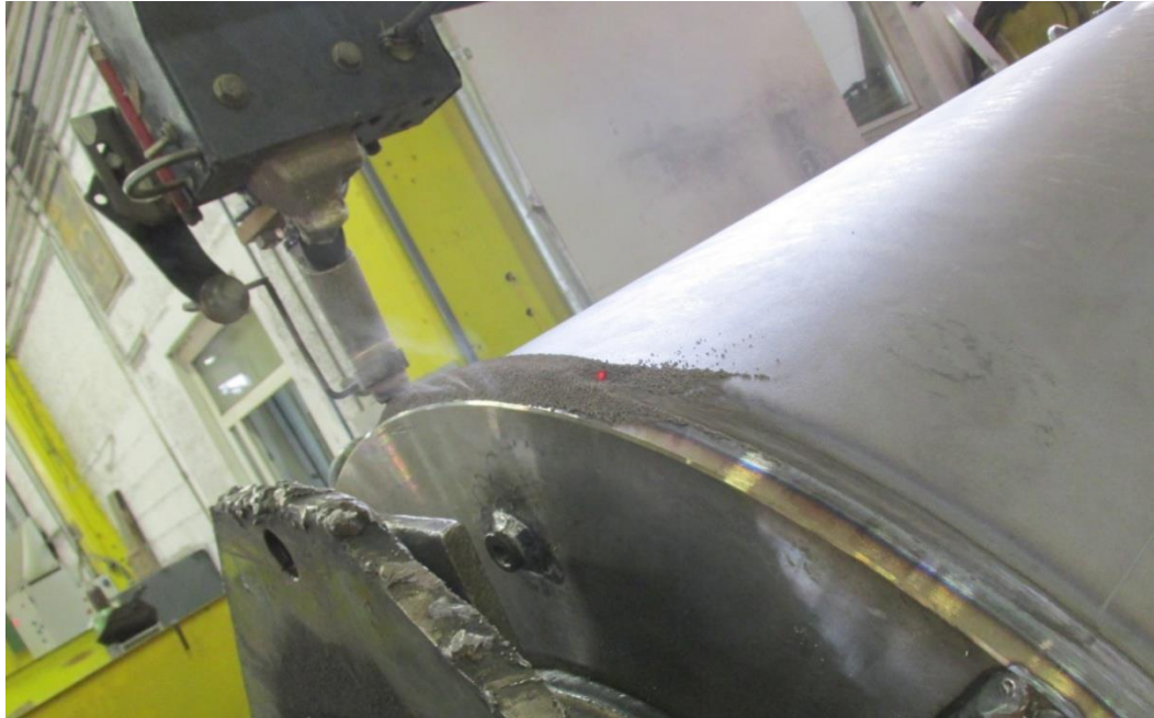
Slika 6.7 Izgled zavarenog spoja nakon zavarivanja[9]
